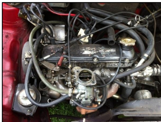
Figura 4.27: Cable y barras del acelerador original
