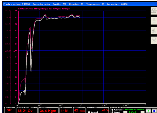
Figura 4.43: Curva de potencia y torque
