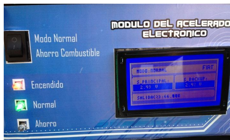
Figura 4.39: Módulo del Acelerador Electrónico – Modo Normal
