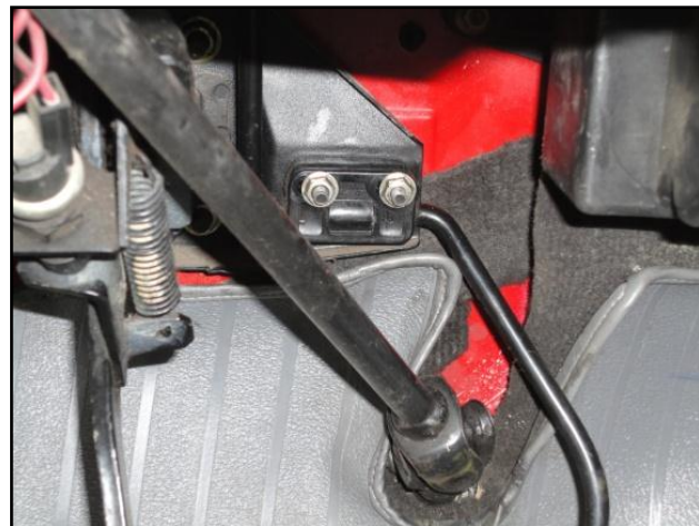
Figura 4.34: Pernos para sujeción de la base del pedal
