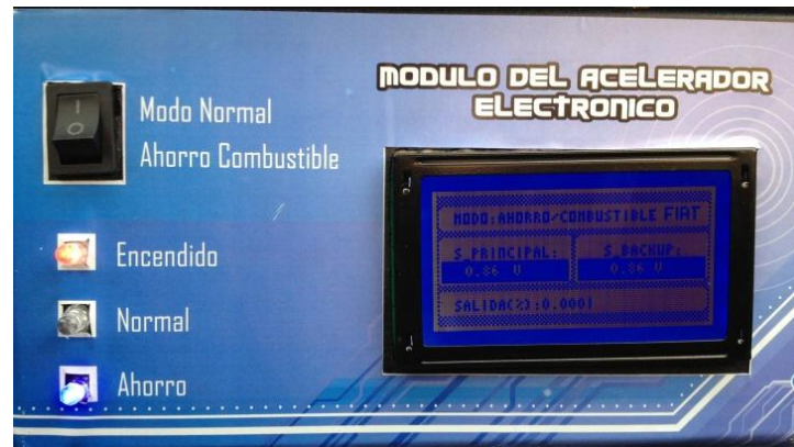
Figura 4.40: Módulo del Acelerador Electrónico – Modo Ahorro
