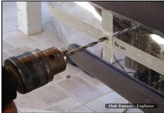
Figura N° 13: Taladrar los agujeros para los sensores y la cámara
