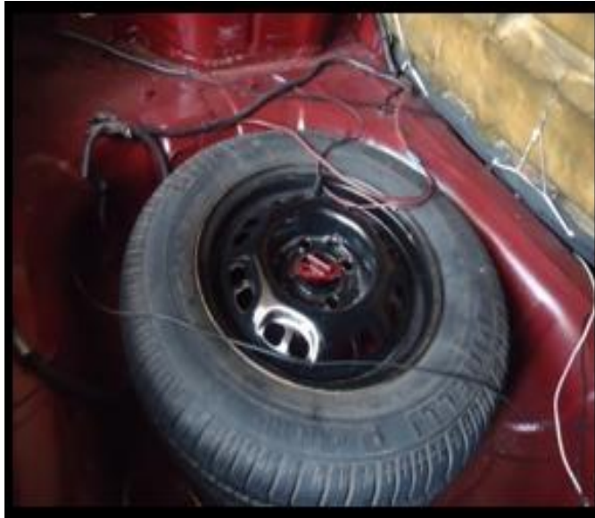
Figura N° 57: Los cables que pasan por la cajuela
