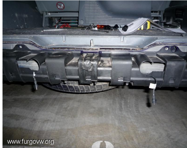
Figura N° 21: Ver por donde enviar el cableado
