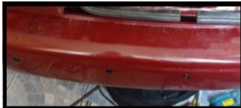
Figura N° 70: Colocación de los sensores
