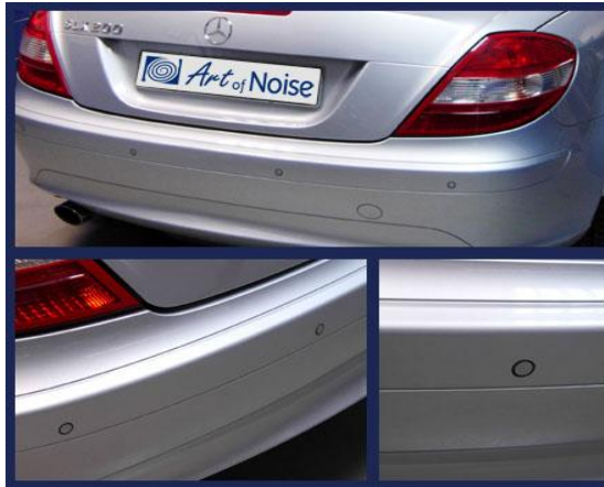
Figura N° 23: Así queda lista la instalación de los sensores y la cámara Fuente: Club Ranger Explorer
