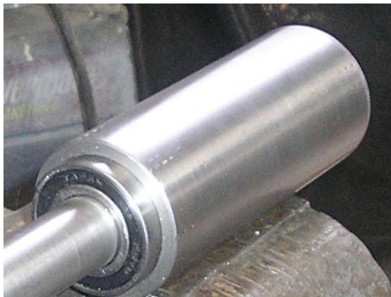
FIG. 4.26 CHUMACERA PARA EL MOVIMIENTO DEL PLATO PORTA LIJAS.
