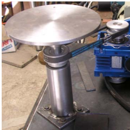
Figura 5.4 Poleas y banda para mover el plato porta lijas con el soporte que tiene ojo chino para regular la distancia y el ajuste de la banda.
