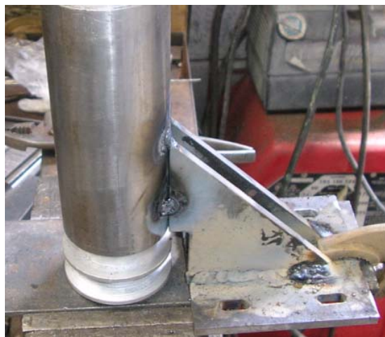
Figura 5.7 Soporte en construcción con ojos chinos para regular el juste de las bandas que van a dar el movimiento a los engranes.
