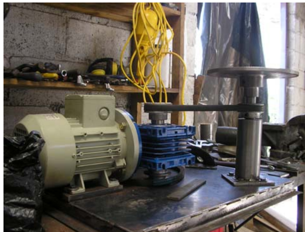
FIG. 4.32 SISTEMA DE MOVIMIENTO DEL PLATO PORTA LIJAS ACOPLADO A LA BASE MEDIANTE 4 PERNOS UNF \frac{1}{4} * 5/16 PLG
