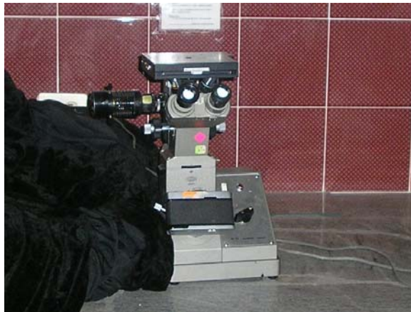
FIG. 2.5 Microscopio electrónico para el análisis de probetas metalográficas (LM FIME)
