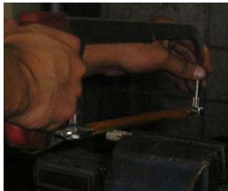
Figura 5.12 Corte de probetas de Acero de Transmisión.
