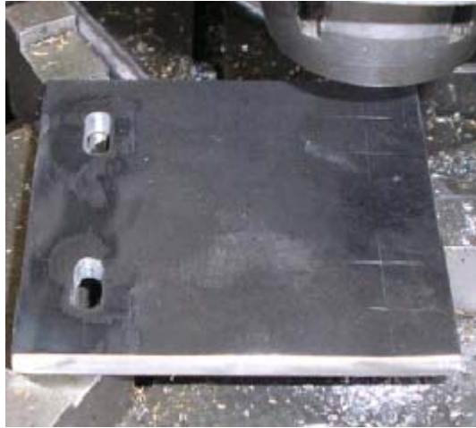
Figura 5.5 Soporte en construcción con dos ojos chinos.
