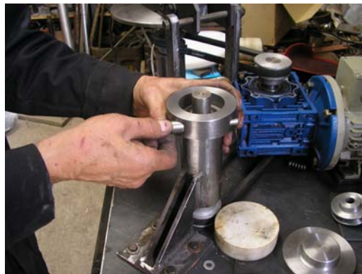
FIG. 4.35 CAMISA DE SUJECIÓN CON PASADOR PLANO.
