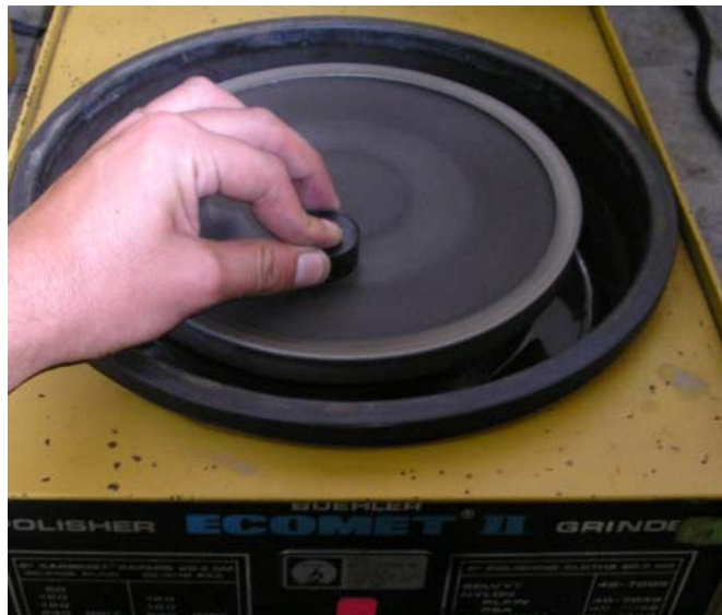
Figura 5.24 Desbaste tosco de la probeta con lija 120.
