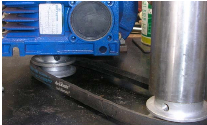
Figura 5.6 Polea y banda inferior que va dar el movimiento de los engranes que se acoplan a la flecha de la polea.
