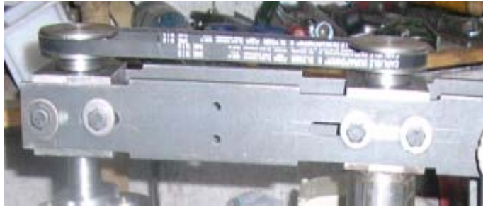
Figura 5.8 Poleas y banda que van a dar el movimiento del porta probetas.
