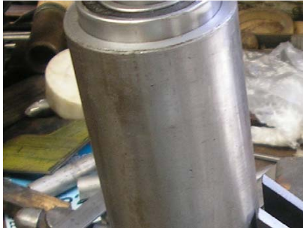
FIG. 4.33 CHUMACERA DEL SISTEMA DE SUJECCIÓN DEL BRAZO VISTA CON EL RODAMIENTO SUPERIOR EN SU INTERIOR.
