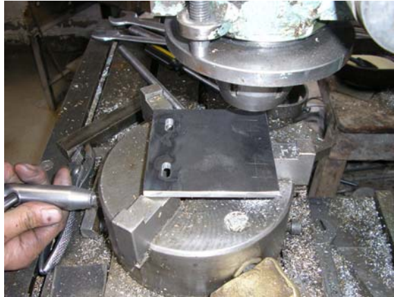
FIG. 4.25 OJO CHINO PARA AJUSTE DE BANDA EN PLACA RECTIFICADA
