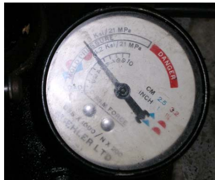
Figura 5.18 Manómetro que indica la presión a la que debe ser sometida el cilindro. 4200 psi.
