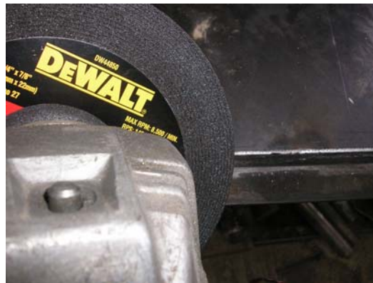
FIG.4.18 ELIMINACIÓN DE PUNTAS CORTANTES DE LA BASE.
