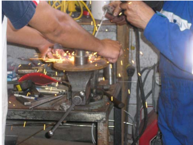
FIG. 4.27 SUELDA DE MANZANA AL PLATO PORTA LIJAS
