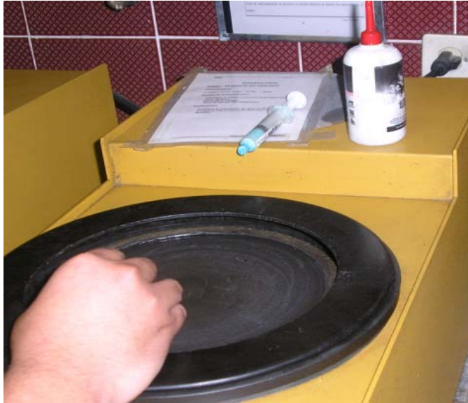
Figura 5.26 Pulido intermedio. Utilizamos pasta de diamante y aceite.
