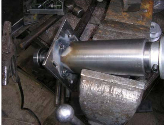
FIG. 4.31 SISTEMA DE PLATO PORTA LIJAS CON RODAMIENTOS, FLECHA Y POLEA CON PRISIONERO \frac{1}{4} * 5/16 PLG.
