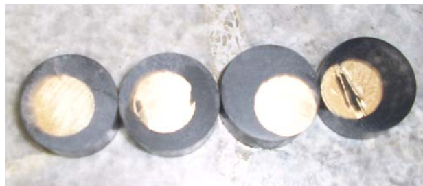
Figura 5.23 Probetas metalográficas de bronce. Resultado final y lista para empezar la prueba.
