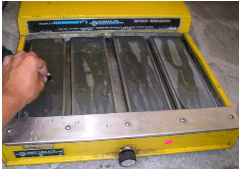
Figura 5.25 Desbaste intermedio y fino. Lijas 240, 320, 400 y 600. En este momento se utiliza la lija 240 para el desbaste.
