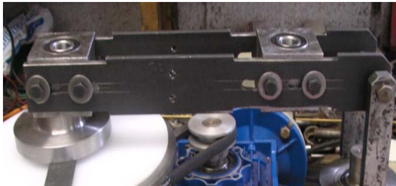
Figura 5.9 Soporte con ojos chinos para regular el ajuste de la banda que va a mover el porta probetas.
