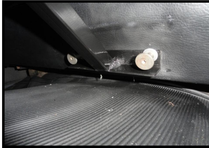
Figura 4.42: Construcción y fijación del soporte al sistema de osciloscopio.
