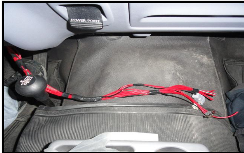
Figura 4.27: Aislamiento del arnés de alimentación y de señales.
