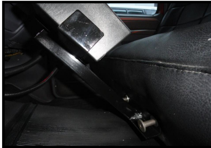
Figura 4.43: Fijación del pedestal a la base.
