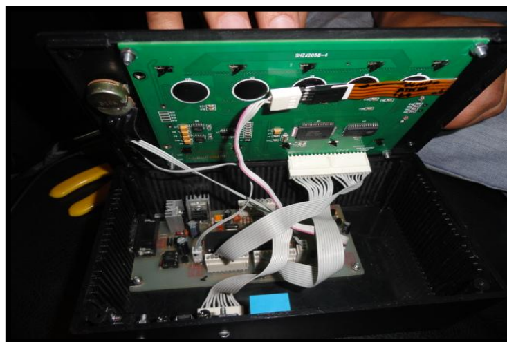
Figura 4.33: Unión de las placas soldadas con la placa de la touch screen.
