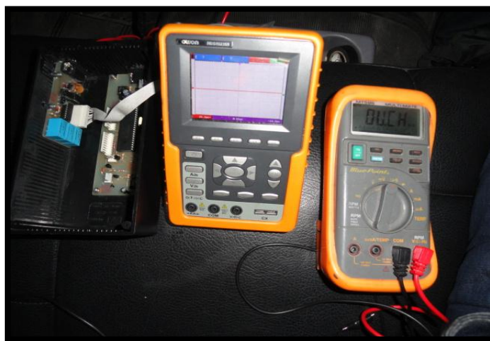
Figura 4.37: Calibración de los divisores de voltaje.
