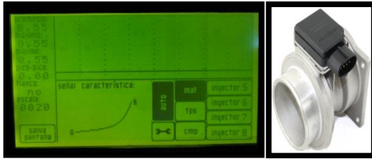
Figura 15. Monitoreo del sensor MAF.
