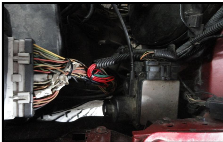
Figura 4.25: Forraje y protección del arnés de cables.
