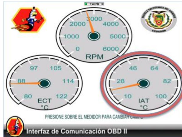
Fig. 5.28. Medición de Sensor IAT (Intake Air Temperature) (Chevrolet Optra 1.8L T/M Design)
