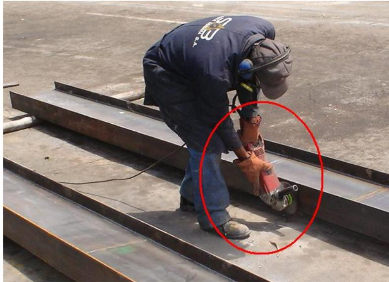
*Fig 3.7 Riesgo al operador por uso inadecuado de amoladora.*
