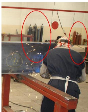
*Fig 3.4 Cilindros en el taller sin sujeción para evitar caídas.*
