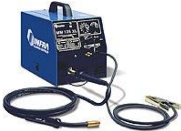
*Fig 2.10 Equipo de soldadura GMAW*
