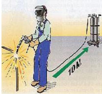
Fig 4.12 Mangueras y cilindros a distancia prudencial de la operación.
