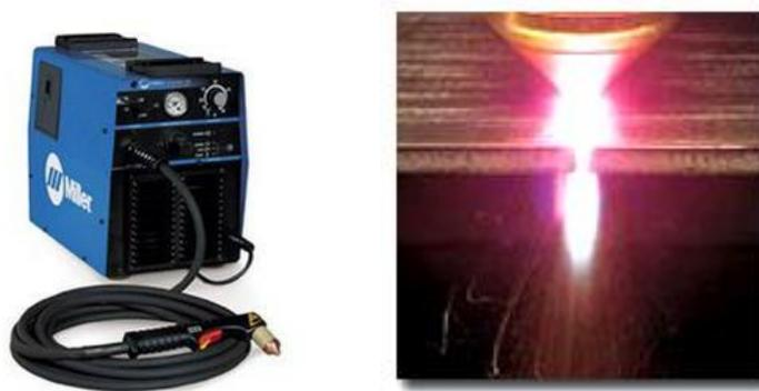
*Fig 2.4 Equipo de corte Miller Spectrum 2050 y Chapa metálica durante el proceso de corte por plasma*
