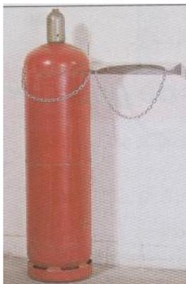
*Fig 4.4 Almacenamiento de cilindros asegurados con una cadena o cordón,*
