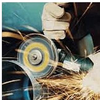
*Fig 2.15 Esmerilado de un metal*
