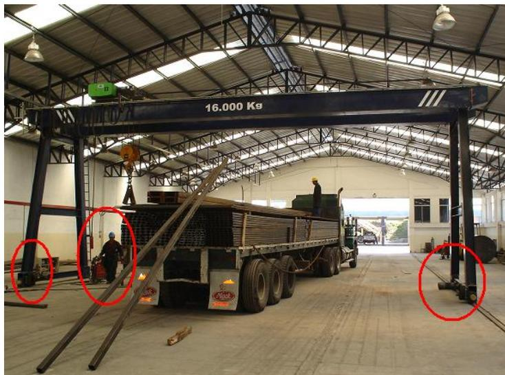
Fig 3.6 Riesgo de golpe al personal y maquinaria por ubicación interna de motores.
