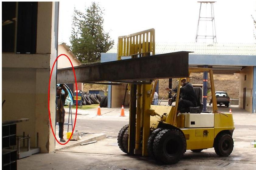
*Fig 3.3 Movimiento de perfiles de acero dentro del taller*
