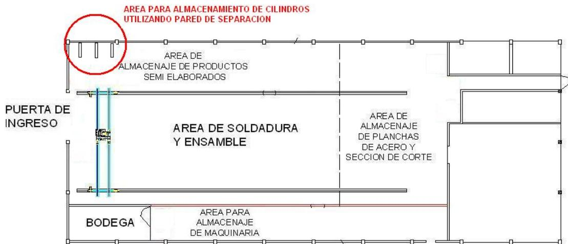
Fig 4.7 Área seleccionada para almacenamiento de cilindros.
