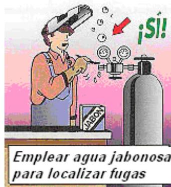
Fig 4.11 Inspeccionar conexiones al cilindro con una solución jabonosa.
