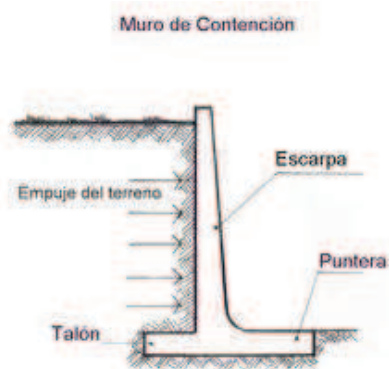
Figura 3.4 : Partes de un Muro de Contención.
