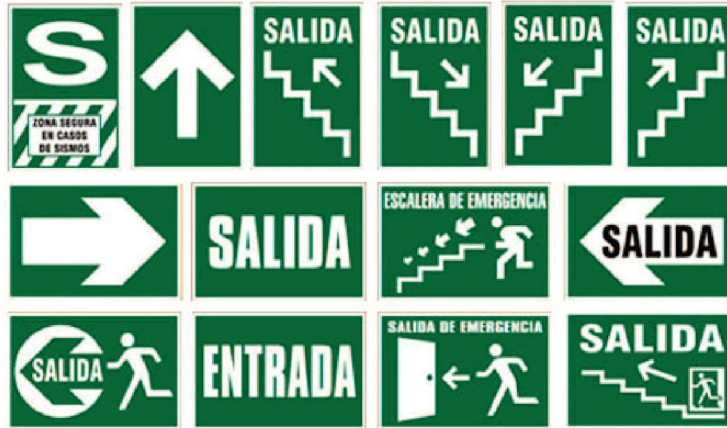
Figura 5.17: Señalización de vías de evacuación.
