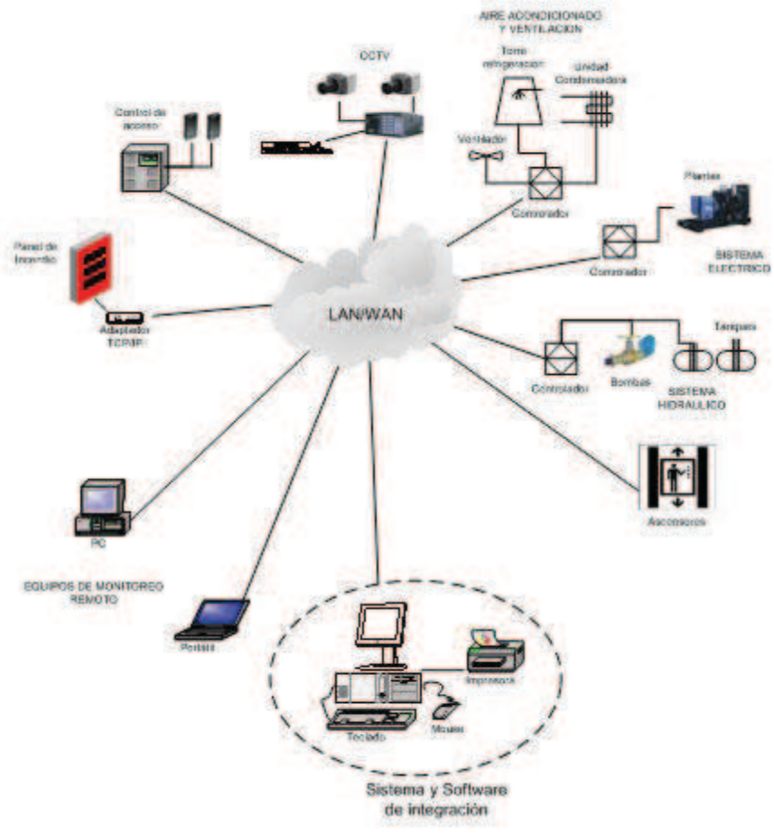
Figura 7.6: Esquema para Automatización de servicios en edificios inteligentes.
