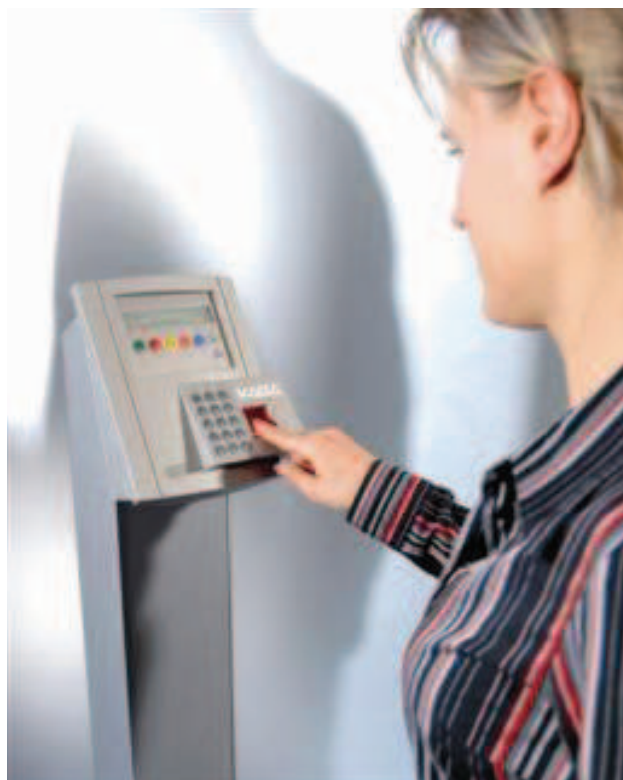
Figura 7.4: Control de acceso biométrico.
