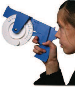
Figura 1.6 : Clinómetro de Mano modernos.
