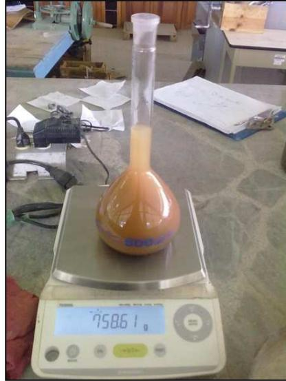
Figura 3.22: Peso Total – Muestra de Suelo y Agua.
