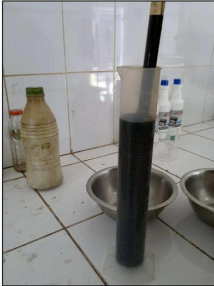
Figura 4.16: Extracción de la parte superior de la muestra contenida en la probeta.
