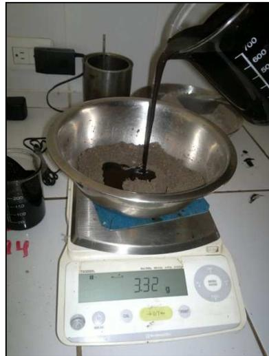
Figura 5.14: Preparación de la mezcla asfáltica
