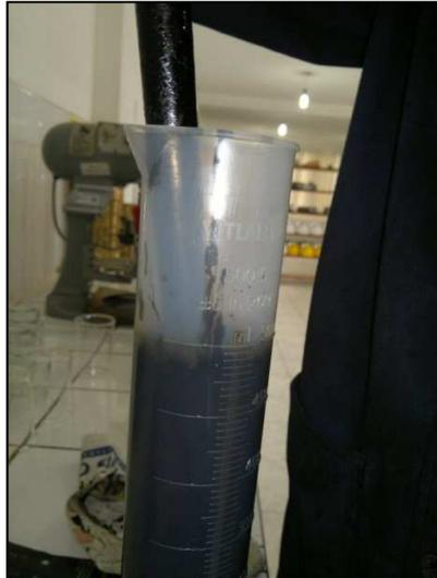
Figura 4.21: Extracción de la parte superior de la muestra contenida en la probeta.
