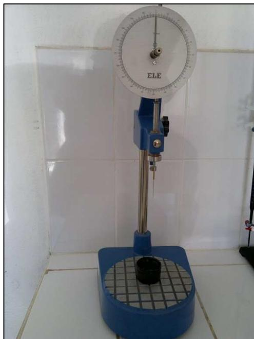
Figura 4.26: Penetrómetro con un peso de 50 g por encima de la aguja.
