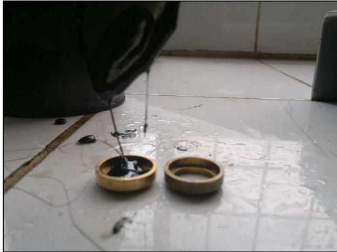
Figura 4.31: Colocación del betún en el anillo.
