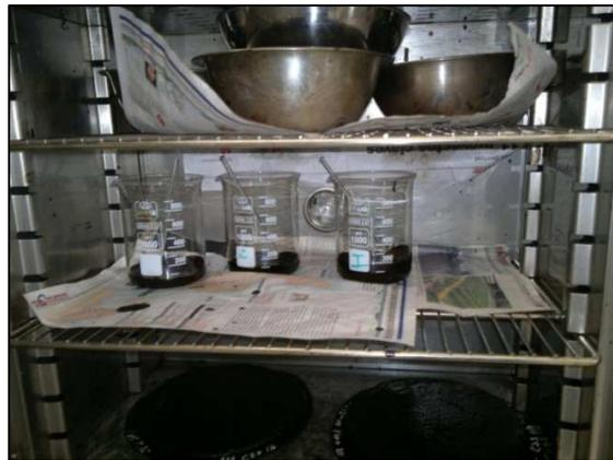
Figura 4.23: Muestras en el horno a  $163 \pm 3^\circ\text{C}$ .
