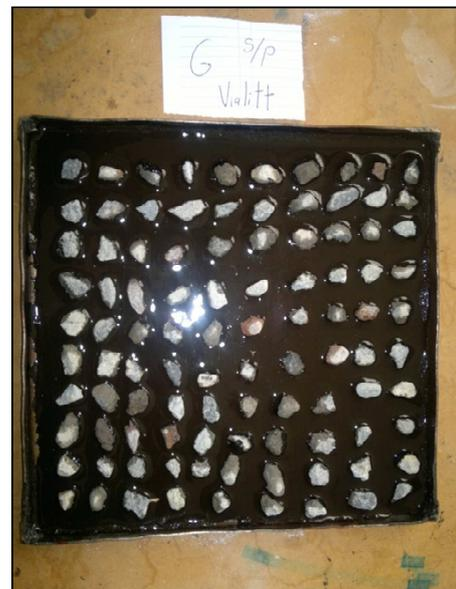
Figura 7.18: Curado de la muestra y Matriz de agregados sobre la emulsión asfáltica
