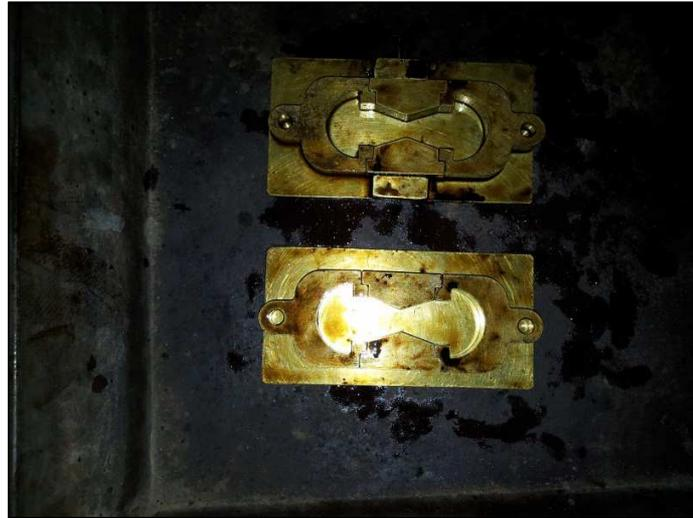
Figura 4.44: Molde para realizar las briquetas.
