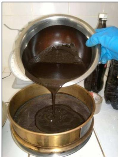
Figura 4.40: Vertido de la emulsión a través del tamiz.
