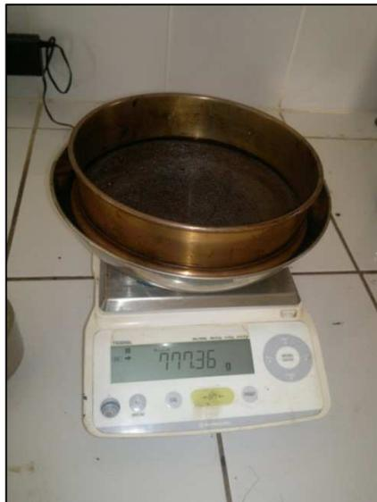
Figura 4.43: Peso del tamiz y la bandeja después del ensayo.
