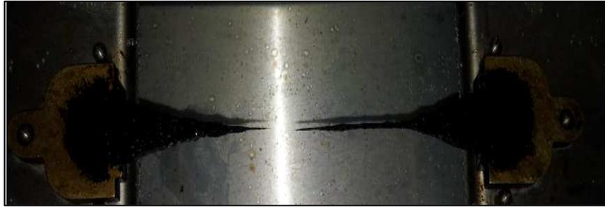
Figura 4.50: Recuperación elástica de las partes separadas de la briqueta
