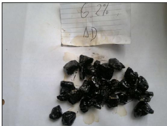
Figura 7.6: Ensayo de Adherencia sobre el agregado empleando emulsión con 2 % de polímero
