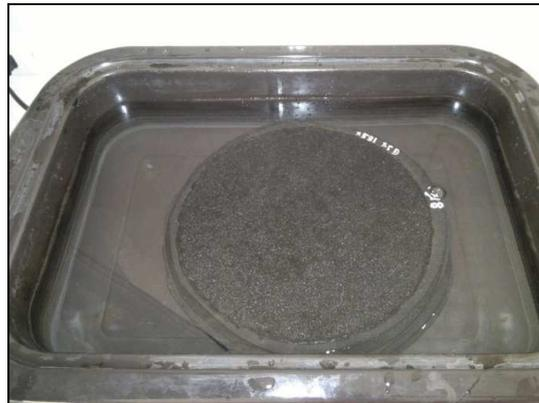
Figura 5.11: Inmersión de las muestras en agua previo a ser ensayadas
