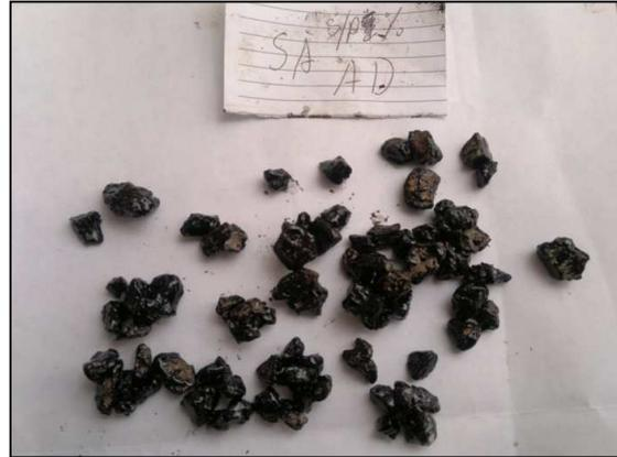
Figura 7.9: Ensayo de Adherencia sobre el agregado empleando emulsión sin polímero
