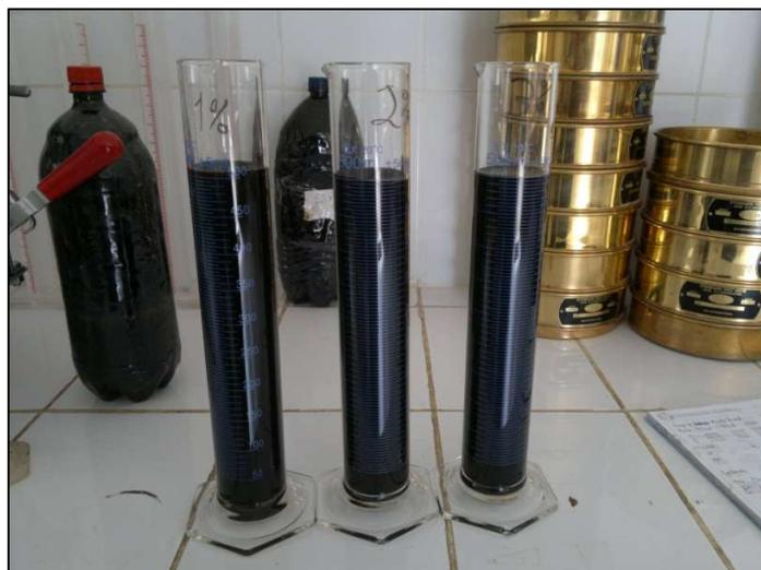
Figura 4.19: Probetas con 500 cm<sup>3</sup> de emulsión asfáltica.
