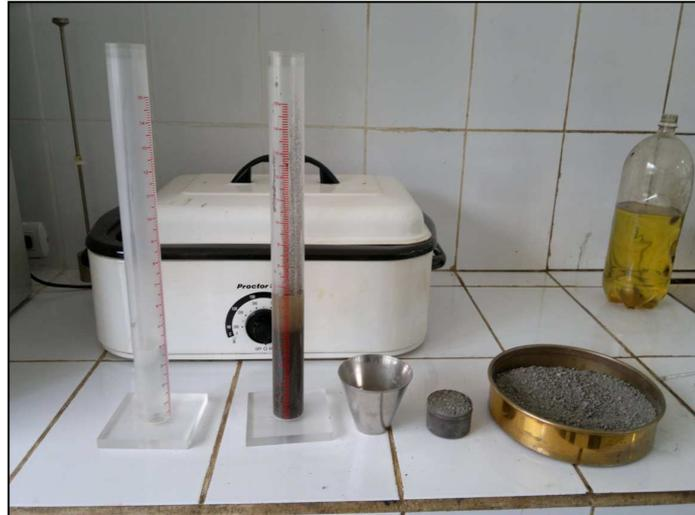
Figura 3.6: Equipo necesario para ensayo de equivalente de arena
