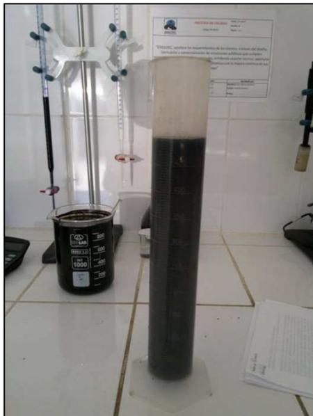
Figura 4.14: Probeta con 500 cm<sup>3</sup> de emulsión asfáltica
