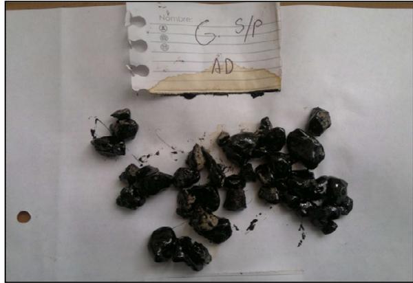
Figura 7.4: Ensayo de Adherencia sobre el agregado empleando emulsión sin polímero
