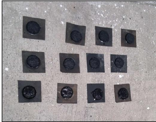
Figura 5.5: Especímenes Ensayo de Cohesión ISSA TB - 139
