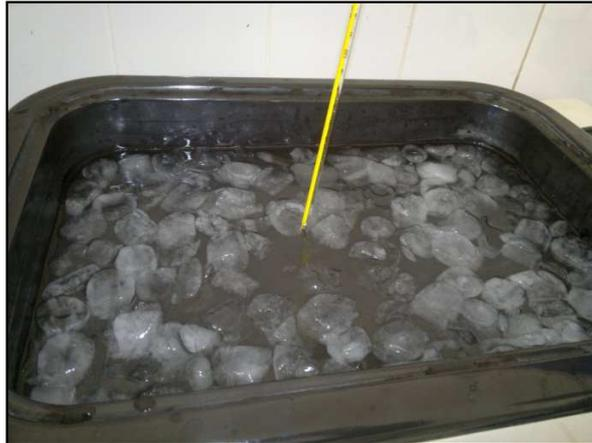
Figura 7.19: Muestra sumergida en agua a  $-22^{\circ}\text{C}$
