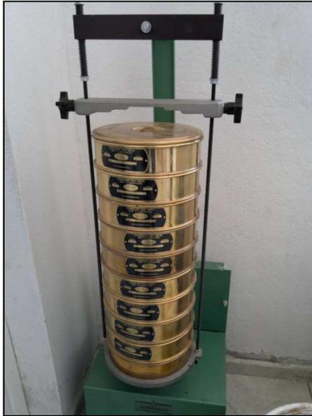
Figura 3.5: Máquina Tamizadora
