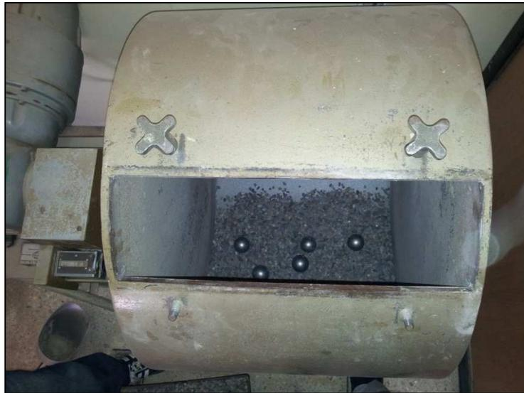
Figura 3.19: Agregado y Carga Abrasiva
