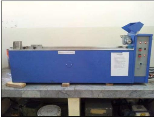
Figura 4.45: Ductilómetro
