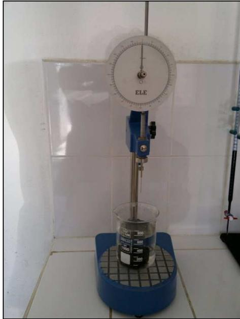
Figura 4.27: Penetrómetro en baño con la muestra a ser ensayada
