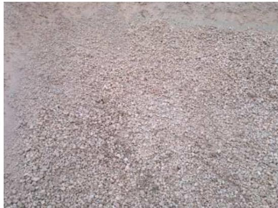
Figura 3.1: Material Pétreo para Micropavimento
