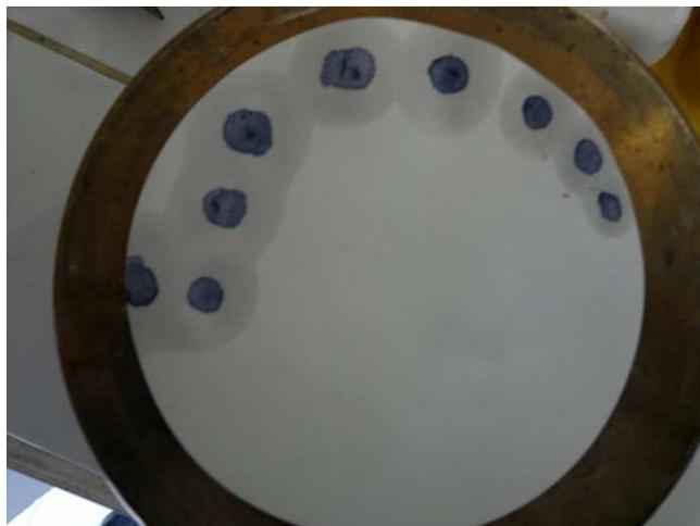
Figura 3.14: Halo de color azul con diferentes dosificaciones de Azul de Metileno
