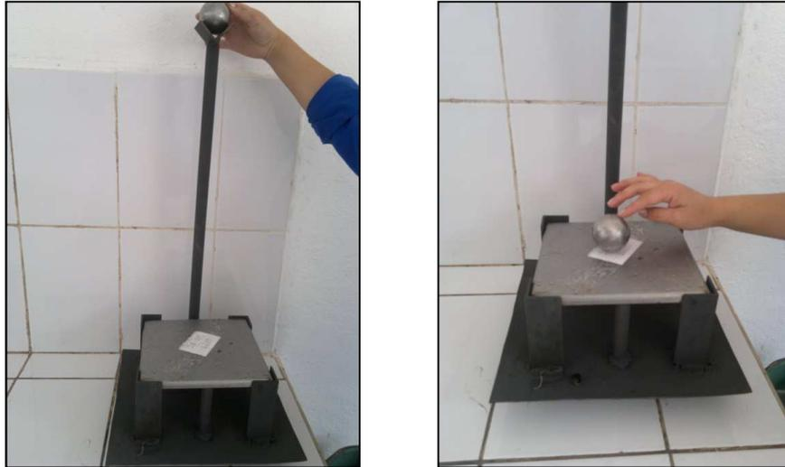
Figura 7.20: Caída libre de la bola de acero sobre la placa invertida
