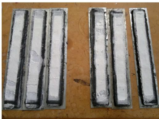
Figura 5.21: Arena adherida a las muestras al finalizar el ensayo
