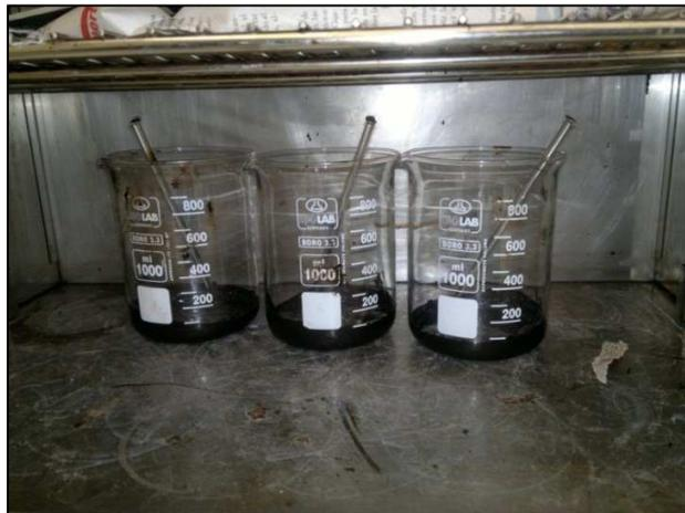
Figura 4.12: Muestras en el horno a  $163 \pm 3$  °C.
