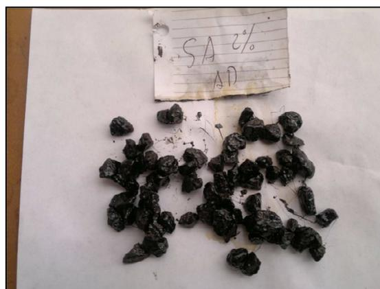
Figura 7.11: Ensayo de Adherencia sobre el agregado empleando emulsión con 2 % de polímero
