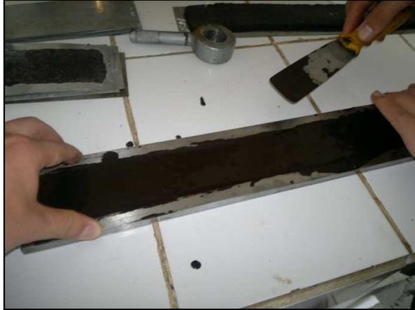
Figura 5.15: Colocación de la Mezcla Asfáltica en el molde
