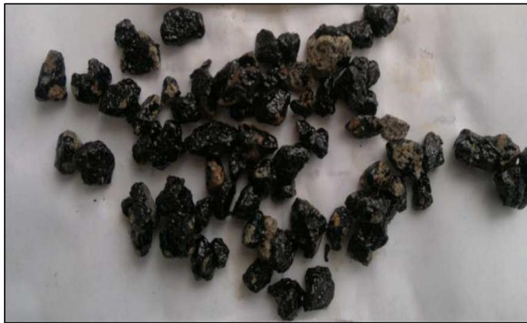
Figura 7.16: Registro visual de la película asfáltica desprendida del material
