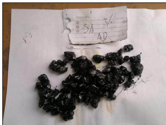
Figura 7.12: Ensayo de Adherencia sobre el agregado empleando emulsión con 3 % de polímero
