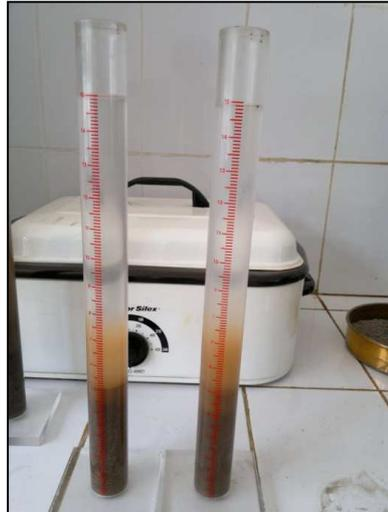
Figura 3.11: Sedimentación de la Arena y Suspensión de los finos.
