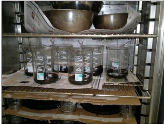
Figura 4.18: Muestras en el horno a  $163 \pm 3^\circ\text{C}$ .
