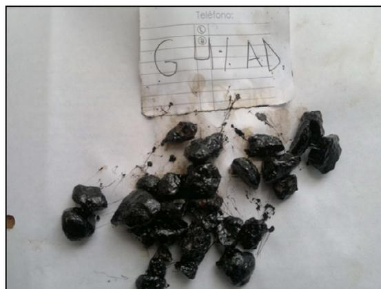
Tabla 7.5: Ensayo de Adherencia sobre el agregado empleando emulsión con 4 % de polímero
