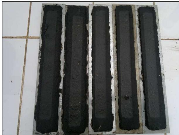
Figura 5.19: Muestra ensayada a 1000 ciclos
