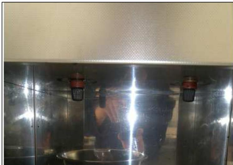
Figura 4.6: Tapón en la parte inferior del Viscosímetro.
