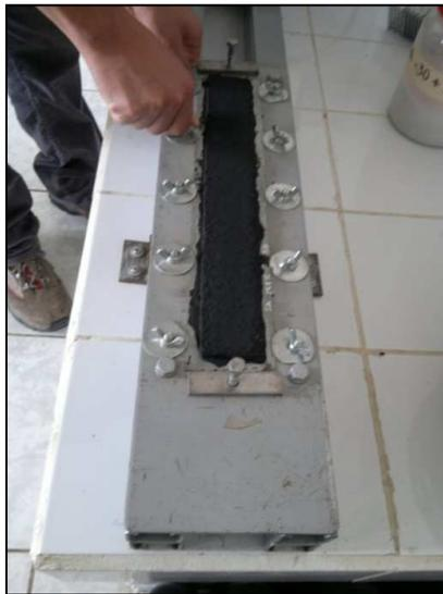
Figura 5.17: Colocación de la Muestra en la Máquina
