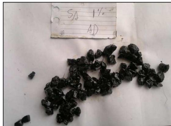
Figura 7.10: Ensayo de Adherencia sobre el agregado empleando emulsión con 1 % de polímero
