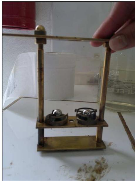
Figura 4.33: Colocación de las esferas sobre los anillos.
