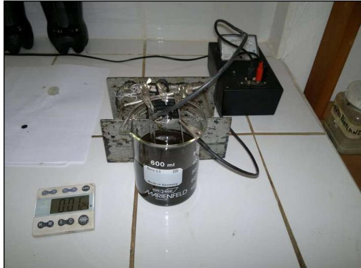
Figura 4.37: Electrodos en la emulsión asfáltica.
