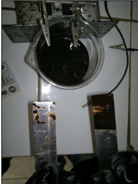
Figura 4.38: Asfalto adherido al electrodo negativo
