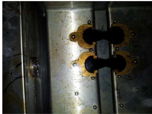
Figura 4.46: Montaje de las muestras en el Ductilómetro
