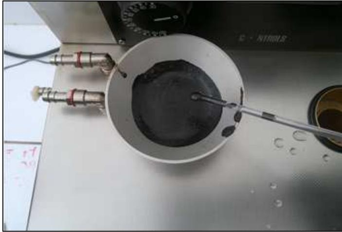
Figura 4.7: Llenado del viscosímetro hasta el borde de derrame.
