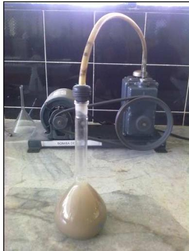
Figura 3.21: Eliminación de Burbujas de Aire.
