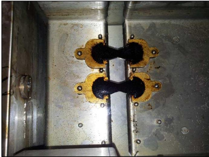
Figura 4.49: Muestra en el ductilómetro a  $25^{\circ}\text{C}$
