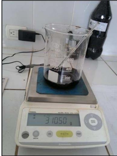
Figura 4.13: Peso de la muestras después de haber permanecido 3 horas en el horno a  $163 \pm 3$  °C.
