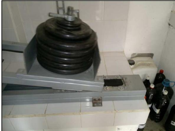
Figura 5.18: Aplicación de la carga en la muestra
