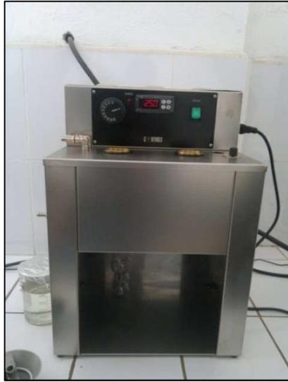
Figura 4.5: Viscosímetro calibrado a 25 ° C.
