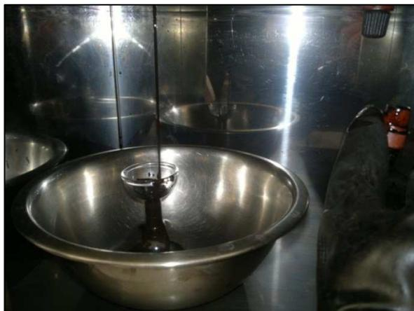
Figura 4.9: Flujo de la emulsión a través del viscosímetro al vaso receptor una vez retirado el tapón de corcho.
