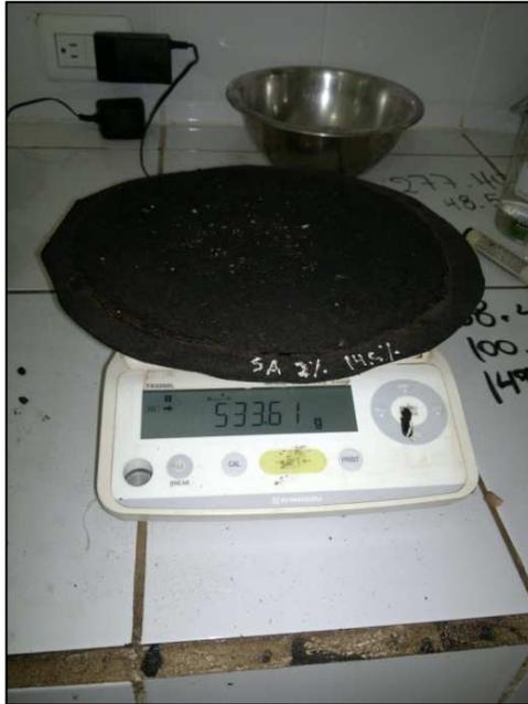
Figura 5.13: Peso de la Muestra al finalizar el ensayo
