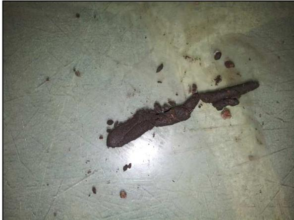
Figura 3.15: Formación del Cilindro
