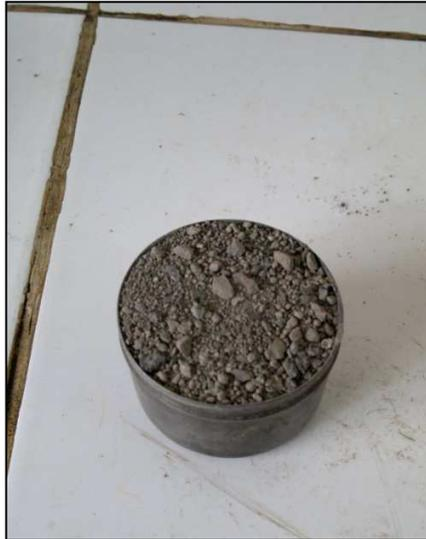
Figura 3.8: Cápsula de agregado pasante del tamiz N<sup>o</sup>4.
