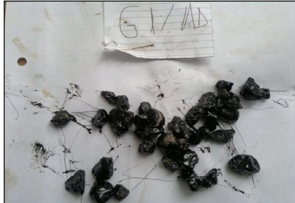
Figura 7.5: Ensayo de Adherencia sobre el agregado empleando emulsión con 1 % de polímero
