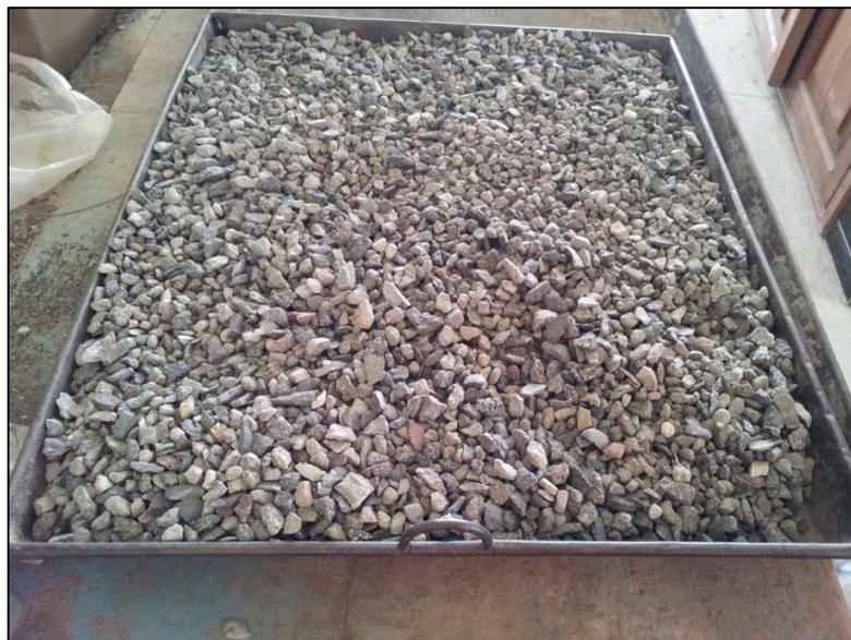
Figura 3.17: Agregado Tamizado
