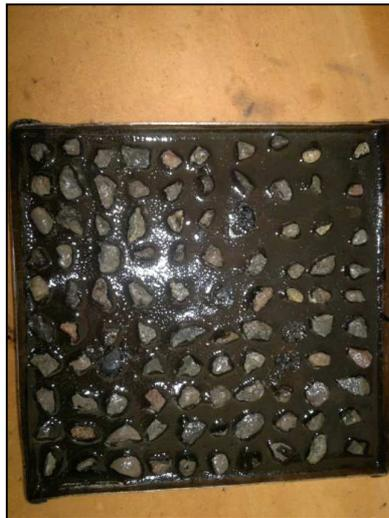
Figura 7.21: Material desprendido luego de ensayar
