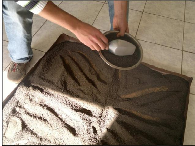
Figura 3.3: Cuarteo del agregado (Norma ASTM C 702)
