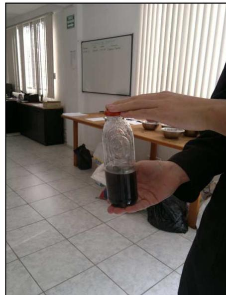
Figura 7.15: Agitación del agregado pétreo
