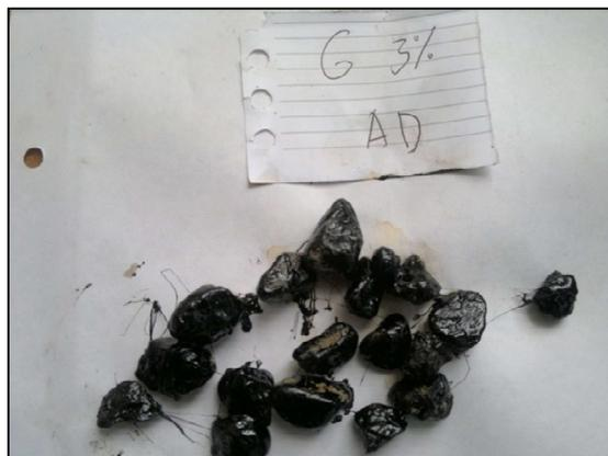
Figura 7.7: Ensayo de Adherencia sobre el agregado empleando emulsión con 3 % de polímero
