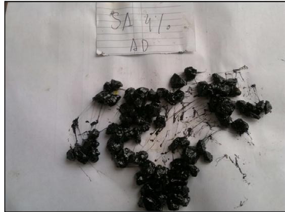
Tabla 7.10: Ensayo de Adherencia sobre el agregado empleando emulsión con 4 % de polímero
