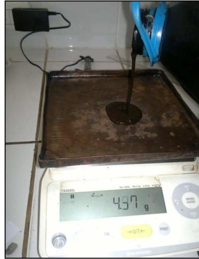
Figura 7.17: Agregado seleccionado y Vertido de emulsión asfáltica sobre placa metálica
