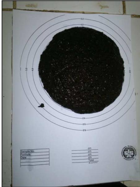
Figura 5.2: Lectura de la Mezcla Asfáltica distribuida en la Escala de Flujo.
