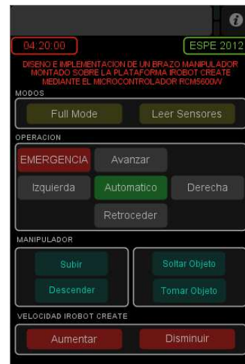
Figura 8. HMI teléfono inteligente – TouchOSC
