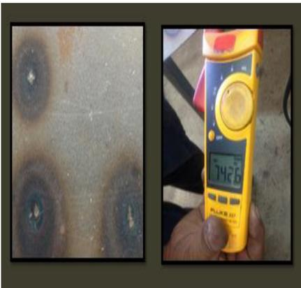
Se determino que gracias a que el tiempo de aplicación de corriente es pequeño y el material del electrodo es un gran disipador de calor que la refrigeración por agua sería suficiente para llevarse el calor excesivo producto de la soldadura. Para determinar la temperatura se utilizo un termómetro
