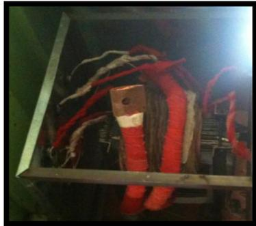
Los diferentes devanados proveen una gama de amperajes que permiten al usuario proveer a los electrodos de soldadura diferentes valores de corriente para soldar varios espesores de placas metálicas. Una ventaja de este tipo de transformador es que ahorra material y espacio, pero se calienta rápidamente, por lo que adicionalmente es aconsejable la colocación de un ventilador para disipar el aumento de temperatura y prevenir que las espiras o el aislamiento sufran daños.
