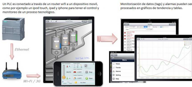
Figura 10. Conexión básica física para el software myscada.
