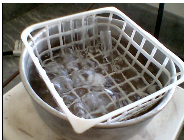
Figura 2.9 Baño de agua a 90° C
