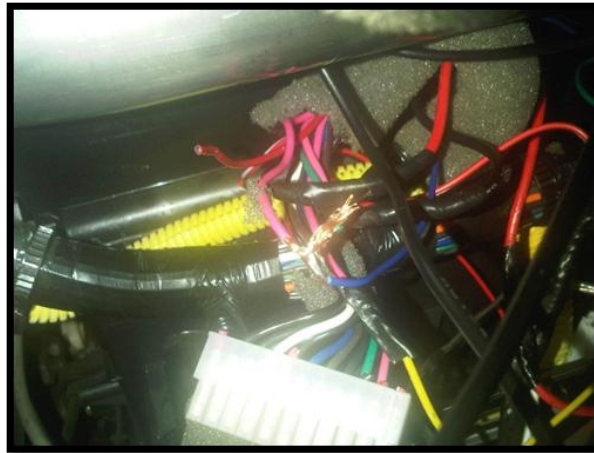
Fuente: Lorena Chuquitarco, Jairo Naranjo Figura 5.1: Cableado entre el Equipo y el Vehículo
