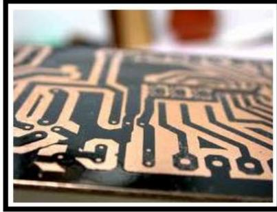
**Figura 3.18: Baquelita con el circuito impreso**
