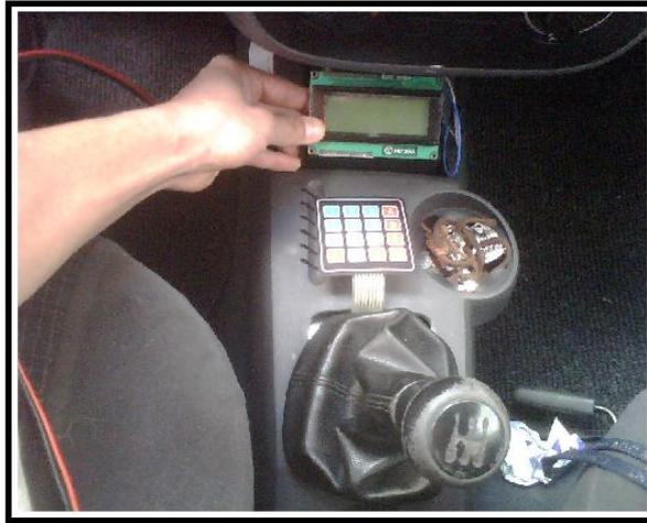
**Figura 4.4: Pantalla LCD y teclado en el modelo VW GOL 2005**
