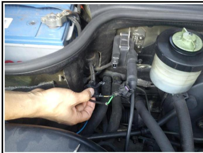
**Figura 4.2: Localización del cable de alimentación de la bobina de encendido**
