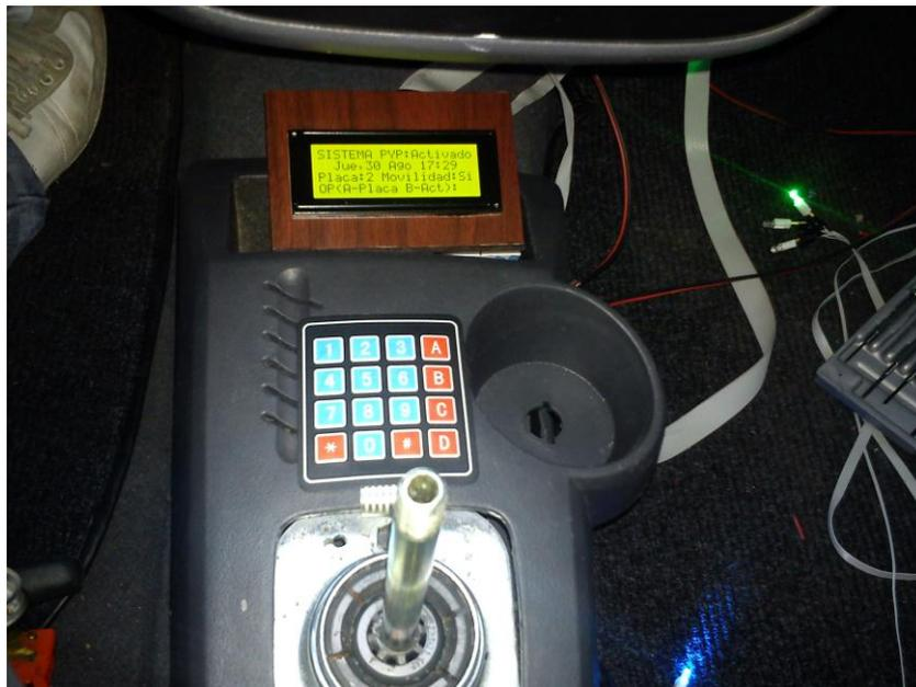
**Figura B.7: Pruebas de visualización del módulo dentro del vehículo**
