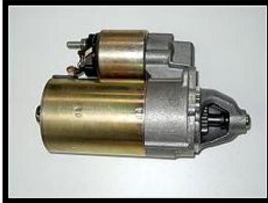
**Figura 2.13: Motor de arranque**
