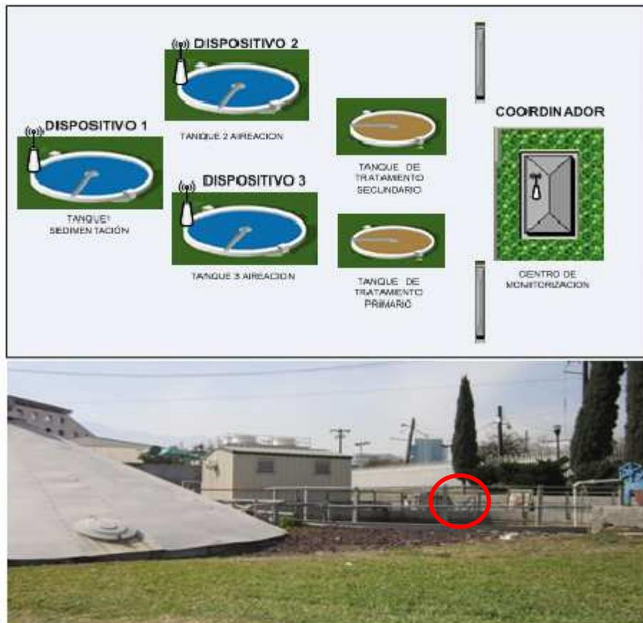
Figura 3.1 Ubicación de los dispositivos finales en las planta de tratamiento
