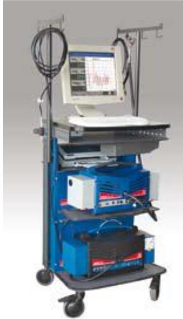
**Figura 3.21 - Analizador de gases**
