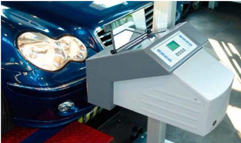
**Figura 3.19 - Regloscopio/Luxómetro**
