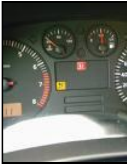
Figura 1.38. Testigo de avería en el tablero
