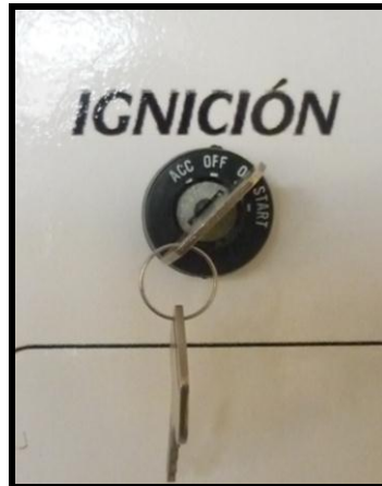
Figura 3.16. Switch de ignición
