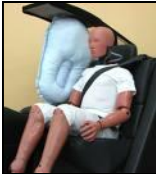
Figura 1.21. Airbag lateral del piloto
