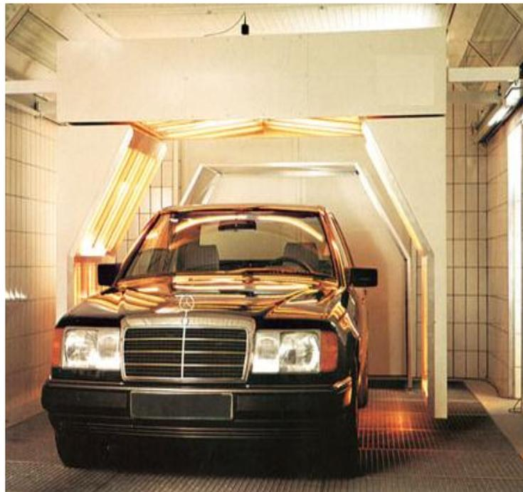
**Figura N° 2.14 Cabina de lámparas infrarrojas**
