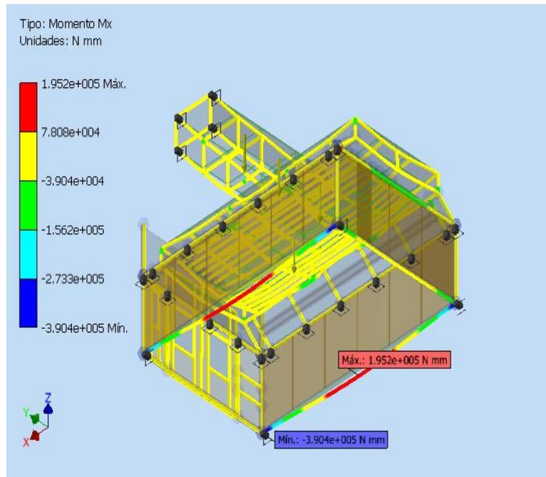
Figura 4.8 Momentos en el eje de las x (Mx)
