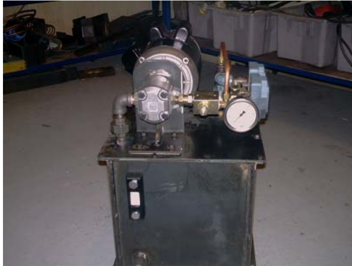
FIGURA 5.2.1 RESERVORIO – UNIDAD DE POTENCIA
