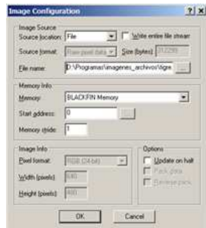
Figura 9. Configuración para cargar imágenes en el ADSP-BF561
