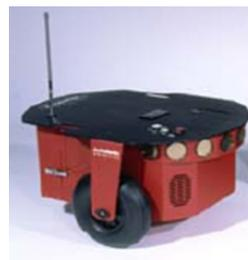
Figura 1. Plataforma Robótica Pioneer 3-DX
