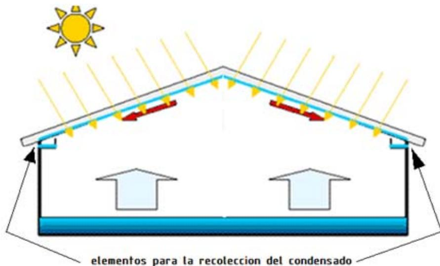
**Figura 2.18** Recolectores del condensado.
