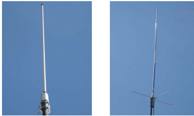
Figura 3.8. Antenas típicas para aplicación de estación base servicio fijo-móvil UHF
