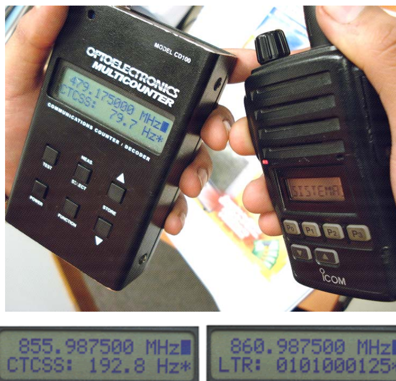
Figura 4.2. Medición de Frecuencia en Sistemas de Radio, HF-VHF-UHF y Troncalizados
