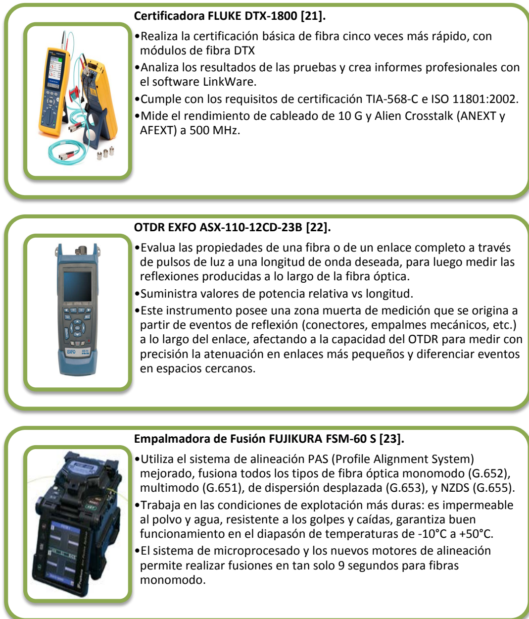
Figura 5.1 Descripción de los Equipos.
