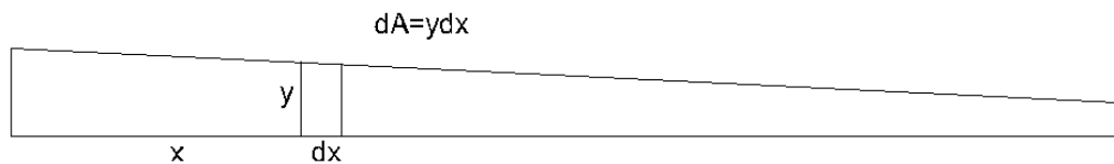
Figura 2.2 Elemento diferencial para el centro de gravedad
