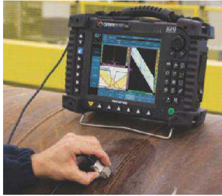
Figura 1.15 Inspección de soldadura por ultrasonido.
