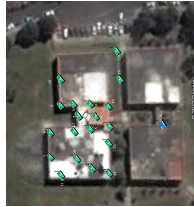
Figura 11. Topología de Red Implementada en Exteriores No.2
