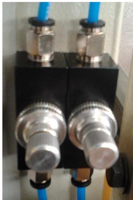
**Figura 5. 6 Válvulas reguladoras de caudal unidireccionales. Fuente propia.**
