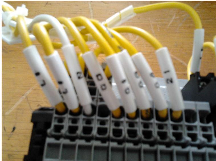
**Figura 5. 2 Marcación de terminales de cables. Fuente propia.**
