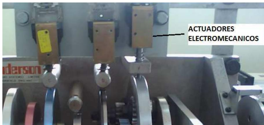
**Figura 2. 10 Actuadores electromecánicos en mal estado. Fuente propia.**
