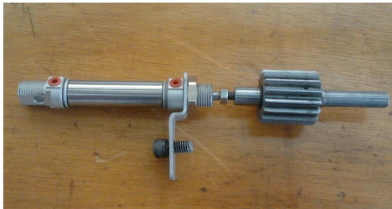
**Figura 4. 1 Pistón acoplado con eje móvil. Fuente propia.**
