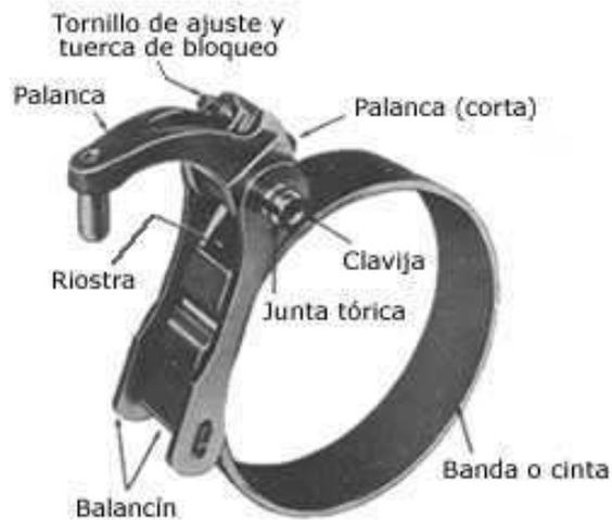
Figura 1. 22 Cinta de freno de caja de cambios. Fuente [30].
