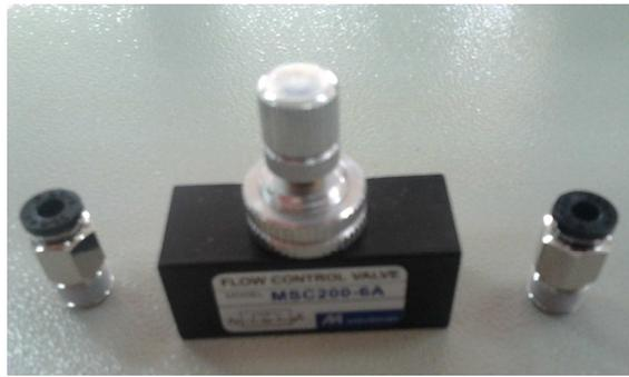
**Figura 5. 12 Válvula reguladora de caudal. Fuente propia.**
