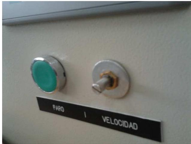
**Figura 5. 4 Potenciómetro de control de velocidad. Fuente propia.**
