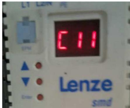
**Figura 5. 10 Regulación de límite de frecuencia máxima en el variador. Fuente propia.**
