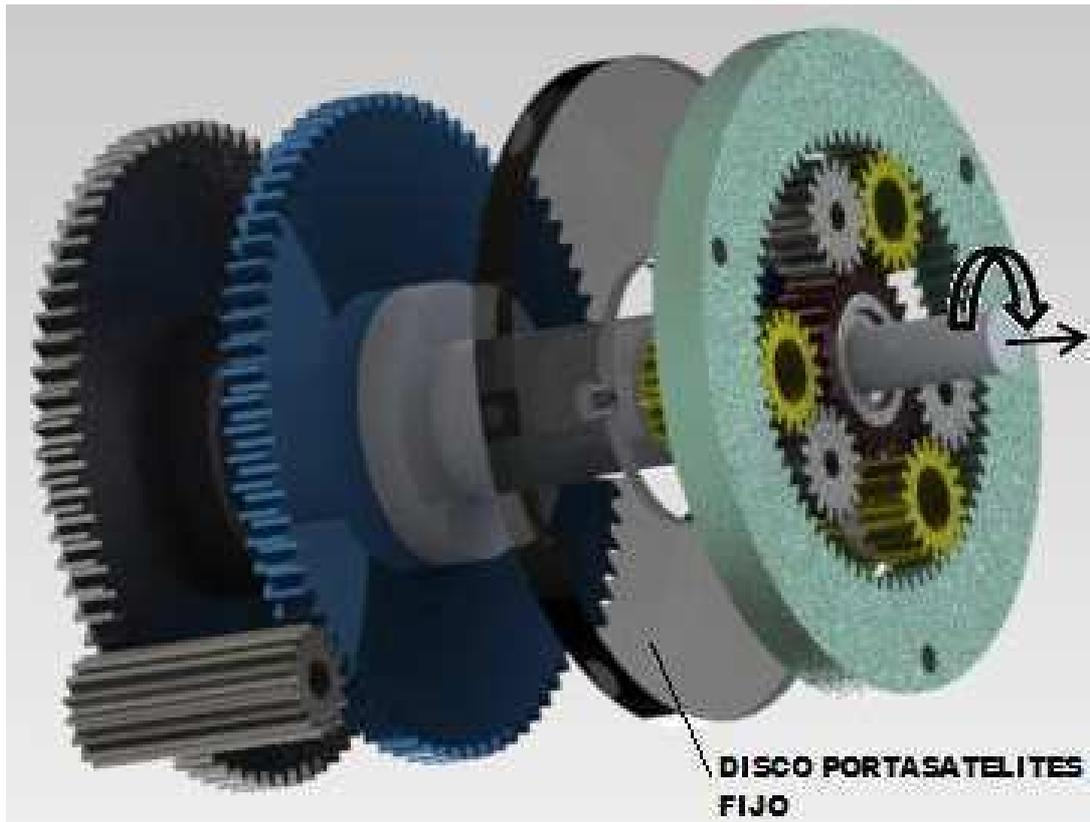
Figura 3. 7 Simulación en SolidWorks de la marcha reversa. Fuente propia.
