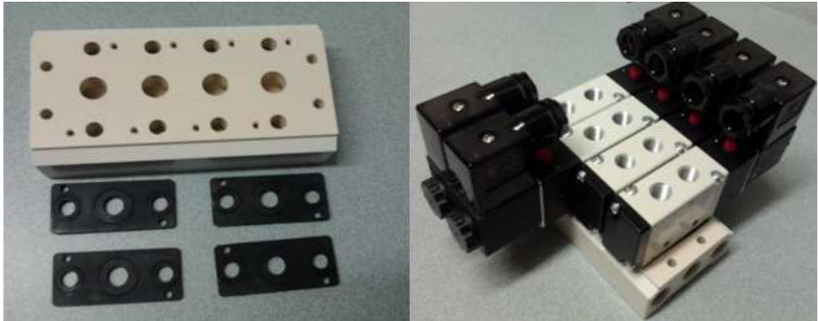
Figura 4. 8 Base manifold y válvulas conectadas. Fuente propia.
