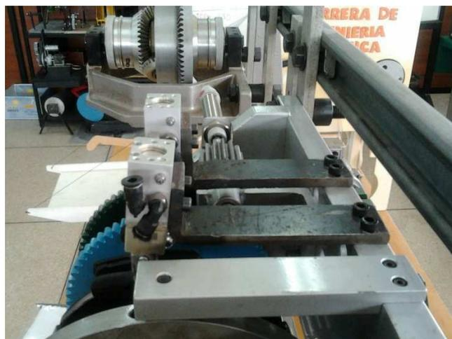
**Figura 4. 13 Soportes angulares para pinzas neumáticas. Fuente propia.**
