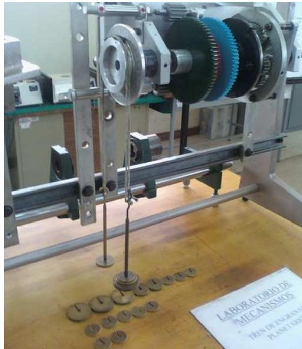
Figura 3. 15 Análisis experimental de torque. Fuente propia.
