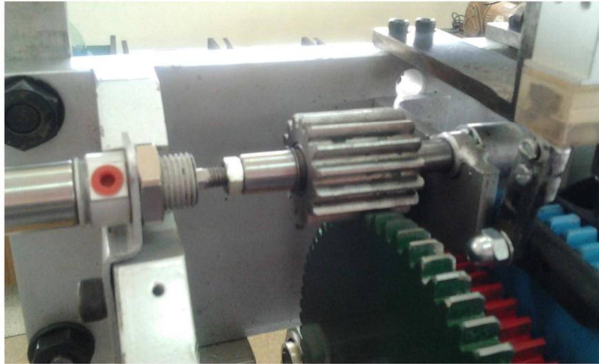
**Figura 4. 2 Eje móvil con soportes axiales. Fuente propia.**
