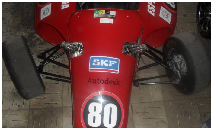
Figura 3.24. Dirección Anti-ackerman Vehículo Cotopaxi II (Fuente: Grupo investigador)
