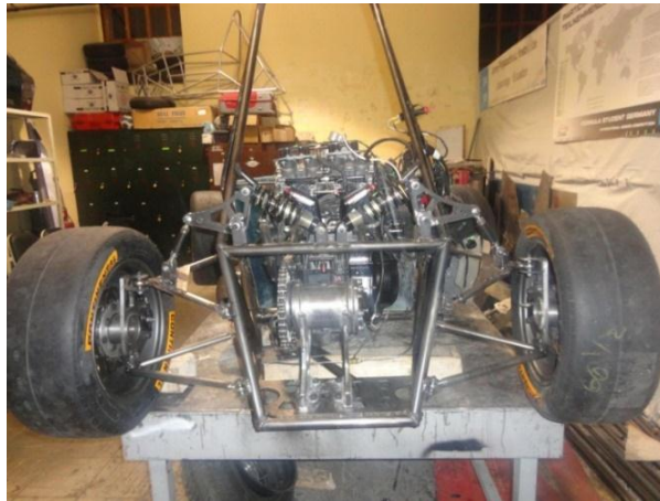
Figura 5.19. Suspensión Trasera Terminada (Fuente: Grupo investigador)
