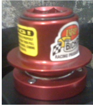
Figura 5.29. Mecanismo de liberación usado en el vehículo Cotopaxi II (Fuente: Grupo investigador)
