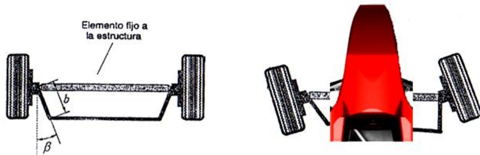
Figura 1.32. Dirección basada en el paralelogramo de Jeantaud (Fuente: Grupo Investigador)
