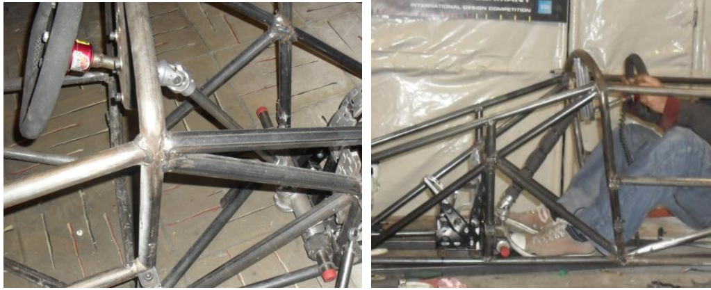
Figura 5.38 Montaje del volante y verificación del mecanismo
