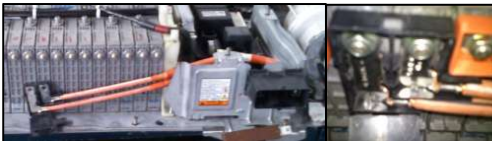
Figura 5.62 Conexionado interno del Jumper de seguridad.
