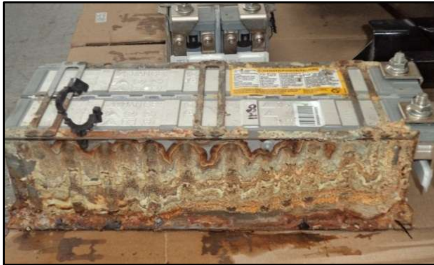
Figura 5.101 Afectación de los electrolitos al pack de baterías.
