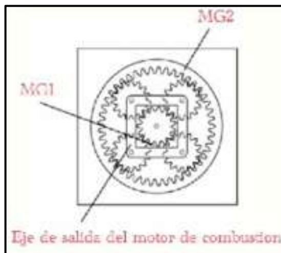
Figura 2.21 Esquema de la constitución de la transmisión
