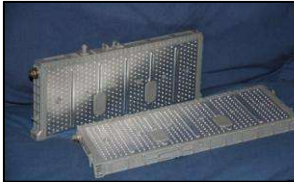
Figura 2.30 Packs de baterías individuales del Toyota Prius
