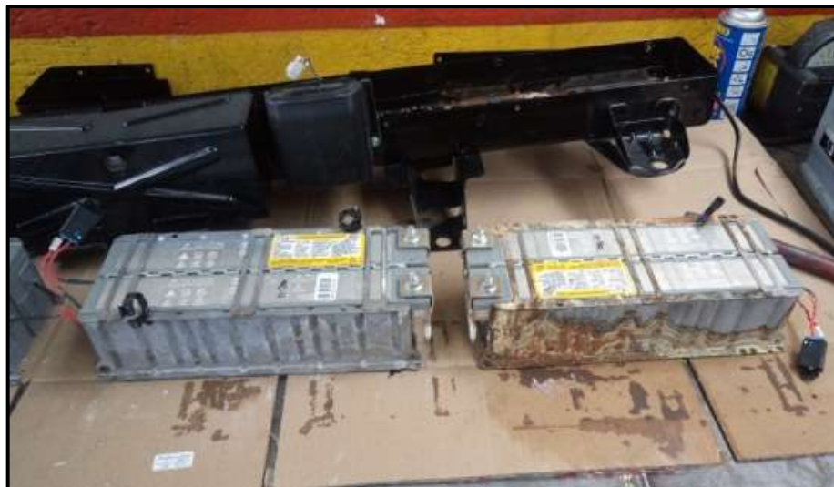
Figura 5.100 Comparación de un pack estallado con otro en buen estado.
