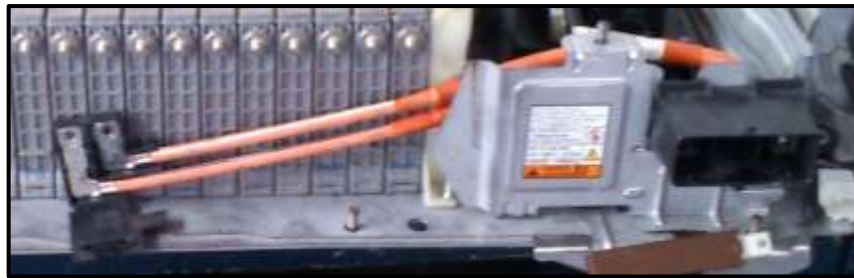
Figura 5.44 Cables del conector del jumper de seguridad.
