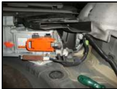
Figura 5.51 Vista del Jumper de seguridad de la Batería de Alta Tensión del Toyota Prius.
