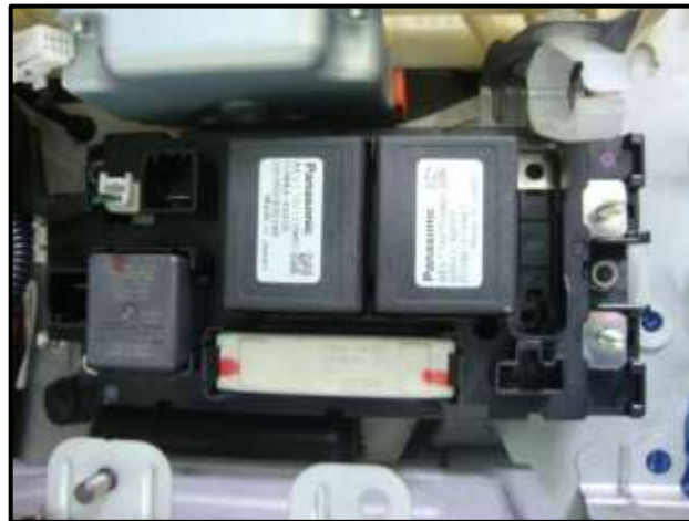
Figura 5.61 Vista de la ECU de la batería y de las salidas de alta tensión de la Batería de Alto Voltaje del Toyota Prius.
