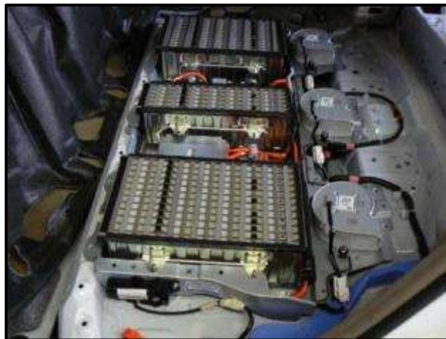
Fuente: http://www.hybridcars.com/hybrid-car-battery Figura 2.33 Batería del Toyota Highlander y del Lexus RX 400h
