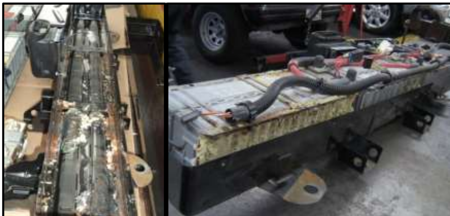
Figura 5.98 Vistas de los packs de batería dañados.
