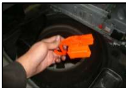
Figura 5.52 Vista del Jumper de seguridad extraído de la Batería de Alta Tensión del Toyota Prius.
