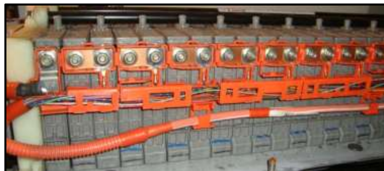
Figura 2.31 Conjunto destapado de la batería del Toyota Prius con todos sus sistemas anexos.
