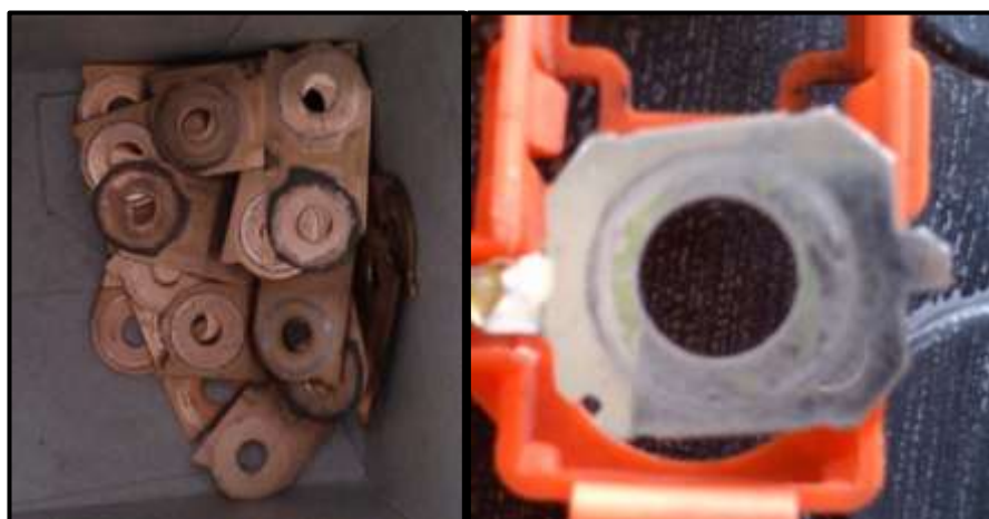
Figura 5.64 Chapas y contactos corroídos.
