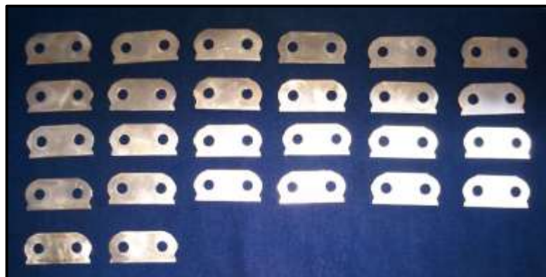
Figura 5.66 Chapas una vez lijadas.
