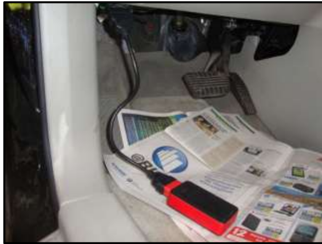
Figura 5.77 Conexión de la Smart Box del Scanner al conector DLC del vehículo.
