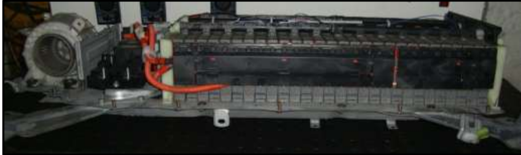
Figura 2.31 Conjunto destapado de la batería del Toyota Prius con todos sus sistemas anexos.
