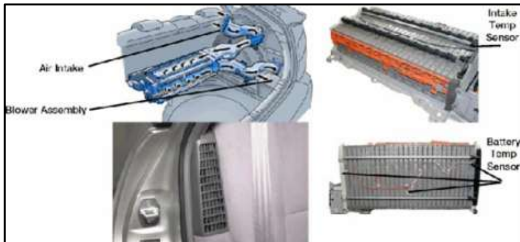
Figura 2.41 Vista del flujo de aire, ubicación de los sensores de temperatura y toma de aire de la batería de alto voltaje (HV) en el Toyota Prius hasta el año 2002.
