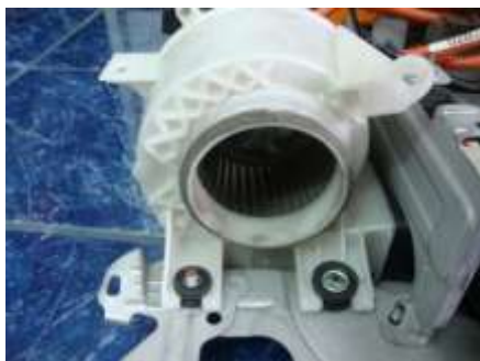
Fuente: Luis Espinosa. Figura 4. Ventilador de la batería.
