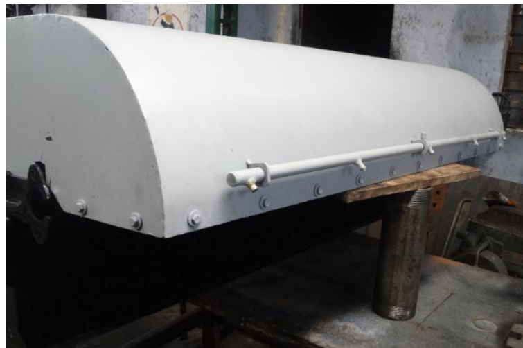
Gráfico No.43: Construcción del riel de aspersores
