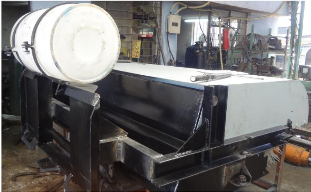
Gráfico No. 52: Montaje del sistema de aspersión
