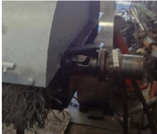
Gráfico No. 51: Acoplamiento del motor hidráulico
