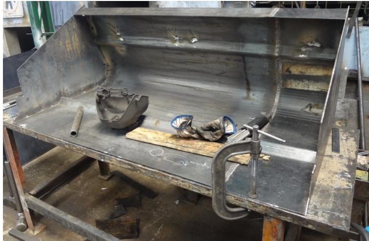
Gráfico No. 39: Construcción del recolector
