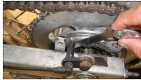
Fuente: Grupo de trabajo Figura 4.30. Holgura entre sensor y rueda fónica posterior
