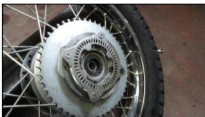
Fuente: Grupo de trabajo Figura 4.19 Fijación entre base y rueda fónica posterior
