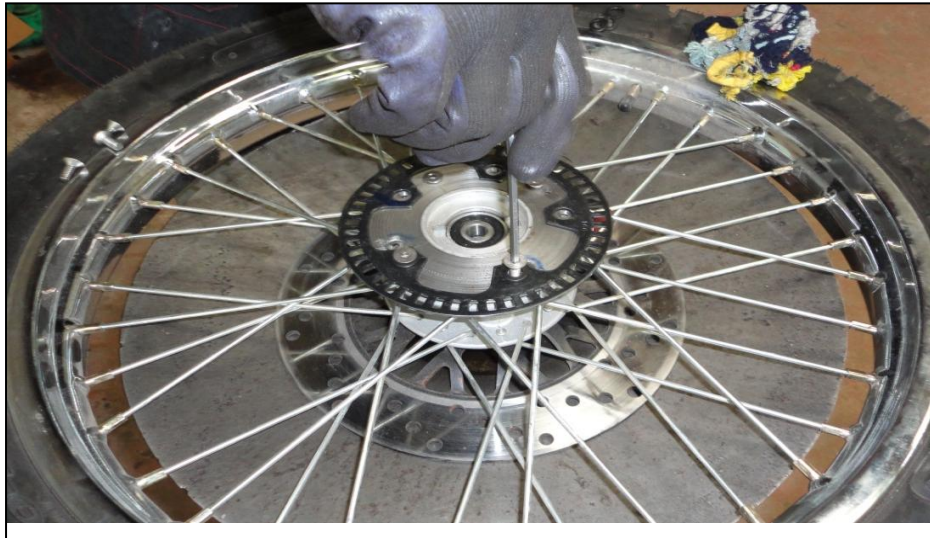
Fuente: Grupo de trabajo Figura 4.18. Pernos de fijación entre base y rueda fónica delantera
