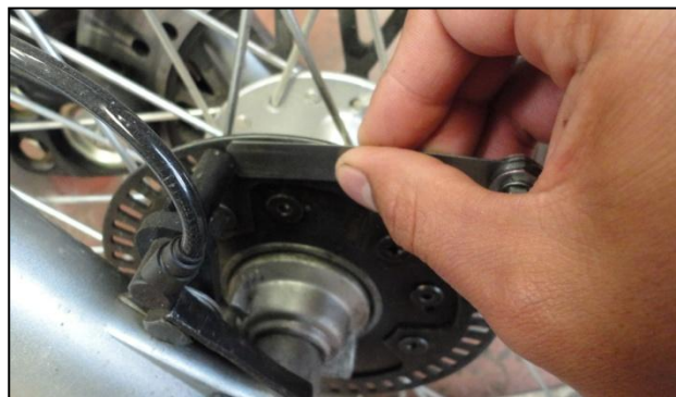
Figura: 4.29. Holgura entre sensor y rueda fónica sensor delantero
