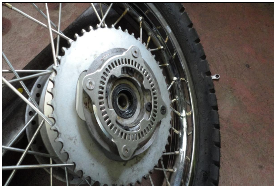
Fuente: Grupo de trabajo Figura 4.19. Fijación entre base y rueda fónica posterior
