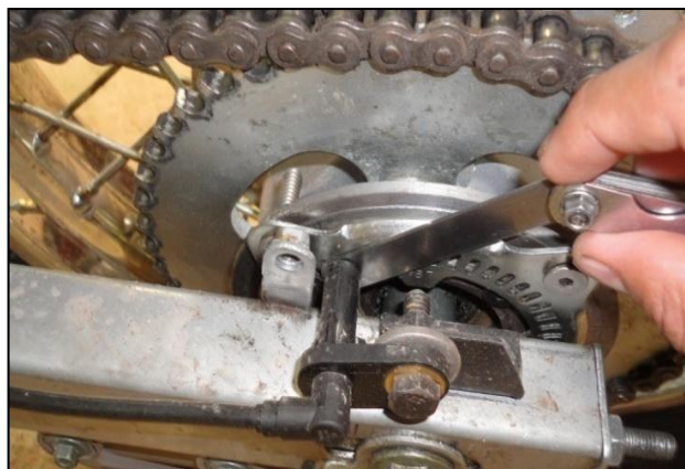
Figura: 4.29. Holgura entre sensor y rueda fónica sensor delantero
