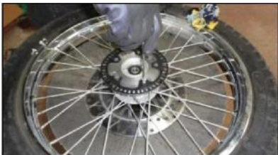
Fuente: Grupo de trabajo Figura 4.18 Pernos de fijación entre base y rueda fónica delantera
