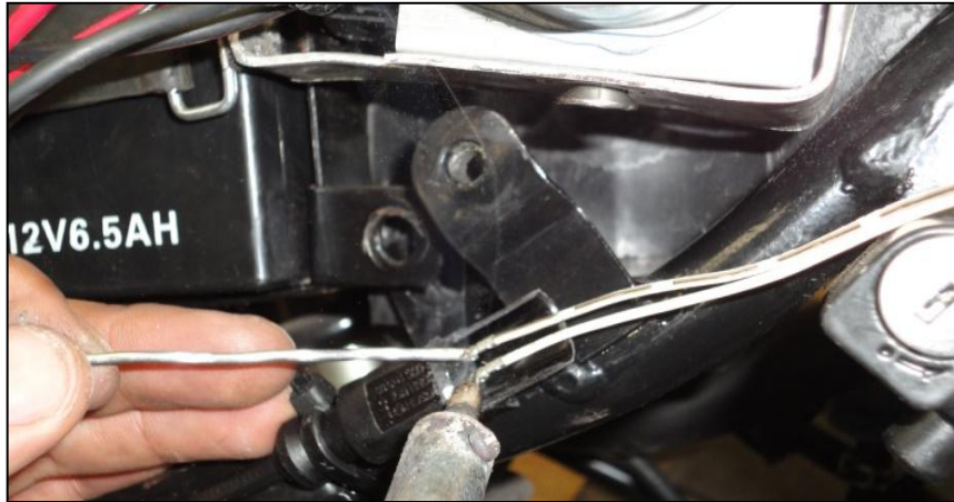
Fuente: Grupo de trabajo Figura 4.32. Soldadura entre cables y terminales del sensor
