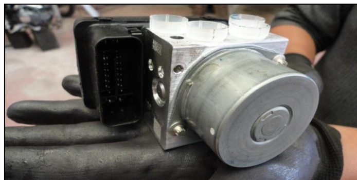
Fuente: Grupo de trabajo Figura 2.20. Hidrogrupo (BOSCH ABS 9.0)
