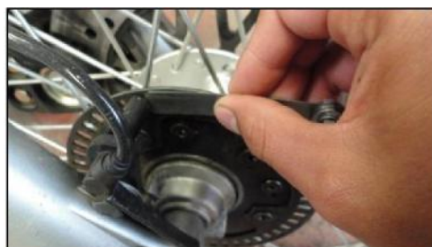
Fuente: Grupo de trabajo Figura 4.29. Holgura entre sensor y rueda fónica delantera
