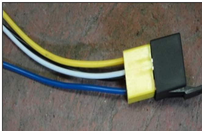
Fuente: Grupo de trabajo Figura 4.37. Relay y conector
