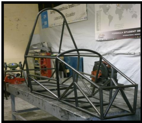
Figura 1d: Bastidor construido.
