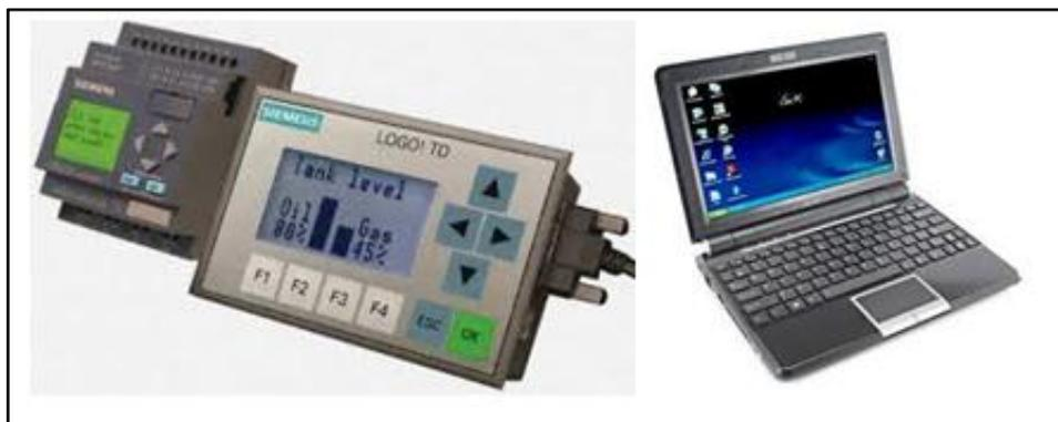
Figura 3: interfaz entre el PLC Siemens logo 230 RC y la PC
