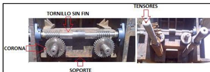
Fig. 3.4. Montaje de las tuercas y tensores
