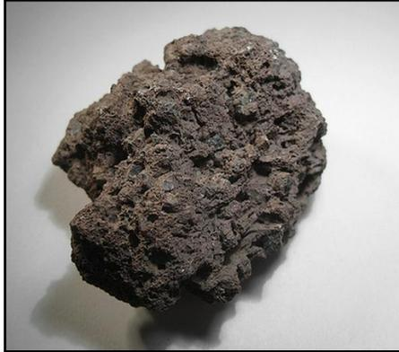
Fig. 1.2. Escoria de fundición por arco eléctrico
