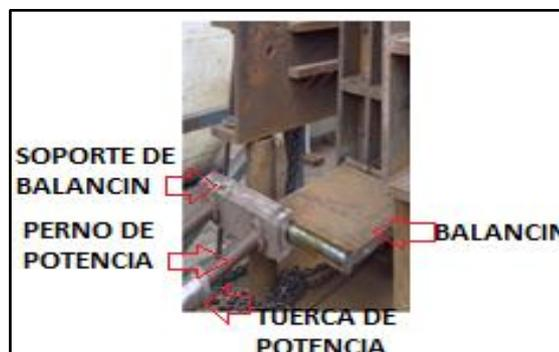
Fig. 3.3. Montaje de balancín y soporte de balancín
