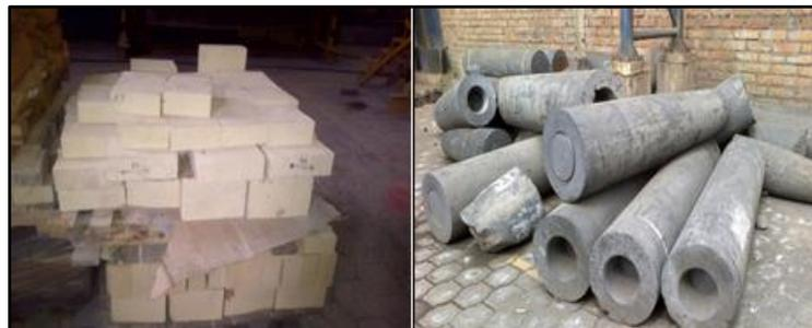
Fig. 1.5. Ladrillos y electrodos deteriorados
