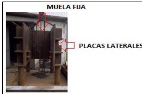
Fig. 3.1. Montaje de la bancada (Muela fija y placas laterales)
