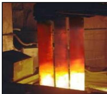
Fig. 1.7. Electrodos de carbono en uso
