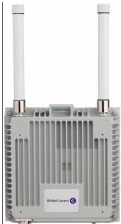
Figura 4.9.- Vista Frontal de la Metro-Cell outdoor 9364 1900-850MHz Alcatel-Lucent [E].
