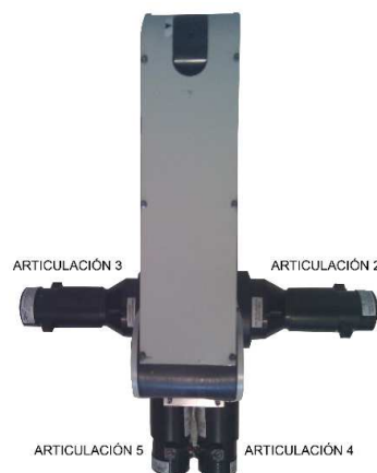
Figura 2.4 Ubicación de los motores de las articulaciones 2, 3, 4 y 5
