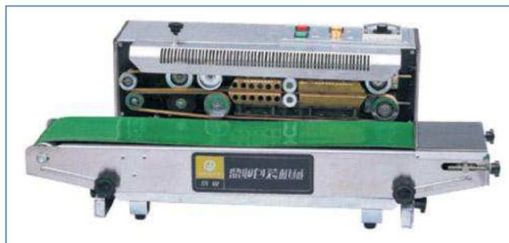
**Figura 1.2 Máquina automática de sellado continuo<sup>2</sup>**
