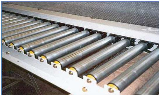
**Figura 3.8 Rodillos de transporte<sup>41</sup>**
