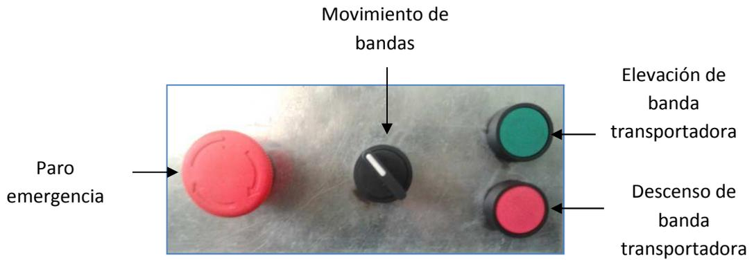
**Figura 6.36 Botonería de la máquina**
