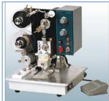
**Figura 1.4 Codificadora automática<sup>4</sup>**
