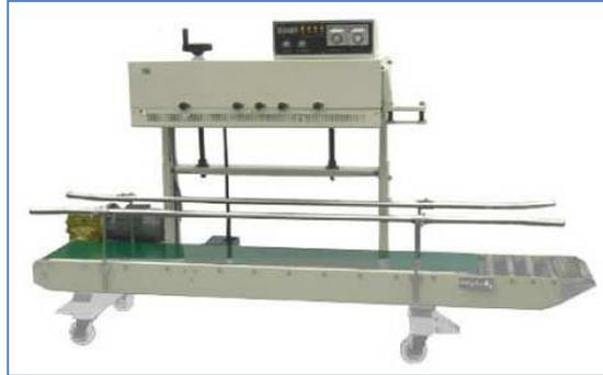
**Figura 2.8 Máquina selladora vertical<sup>13</sup>**
