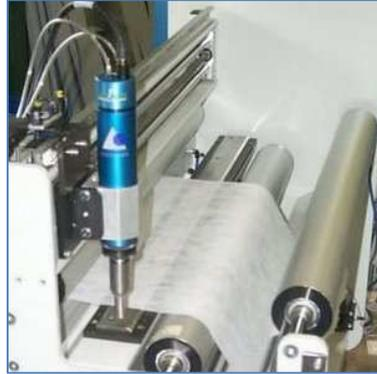
**Figura 3.3 Sellado por ultrasonido**<sup>36</sup>
