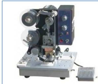
Figura 2.10 Codificadora automática<sup>15</sup>
