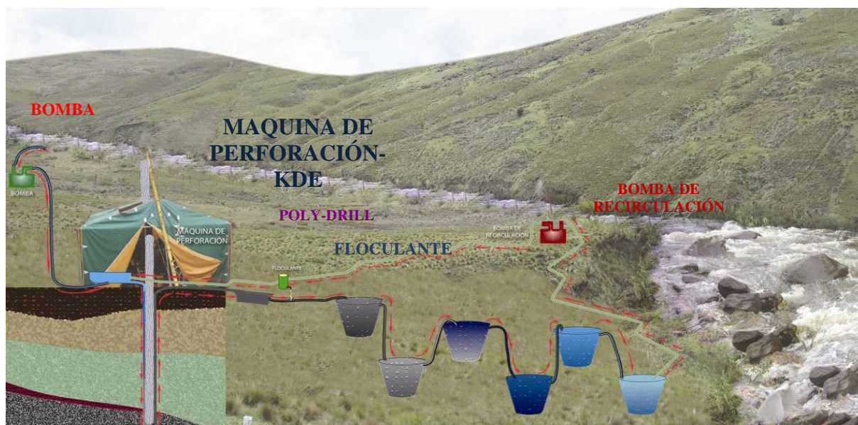
Gráfico No. 5 Esquema de manejo de agua y lodos de perforación
