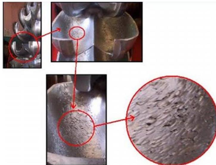
**Figura 2.2** Superficie afectada por erosión
