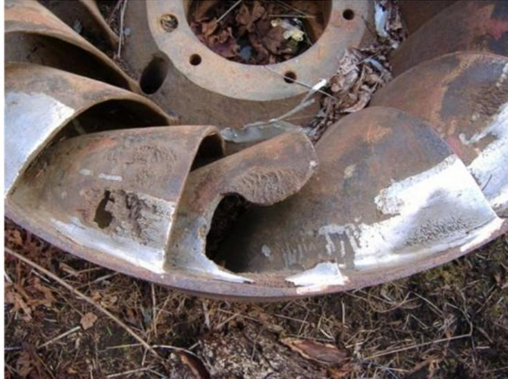
**Figura 2.3** Superficie afectada por cavitación
