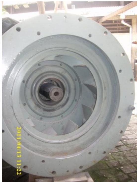
**Figura 3.6** Rodete a instalar en el Proyecto Hidroeléctrico Borja, Guápulo, 2011.
