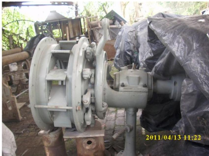
**Figura 3.8** Distribuidor Proyecto Hidroeléctrico Borja, Guápulo 2011
