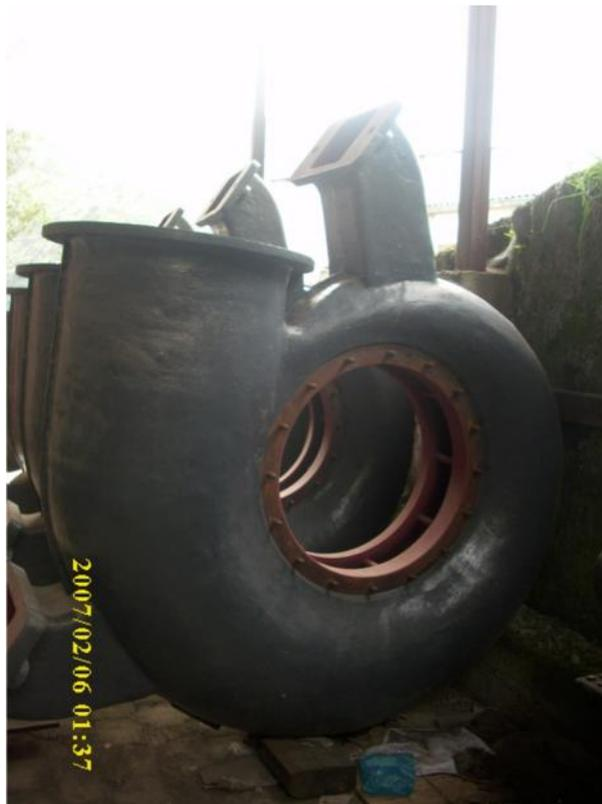
**Figura 3.7** Cámara espiral para Proyecto Hidroeléctrico Borja, Guápulo, 2011
