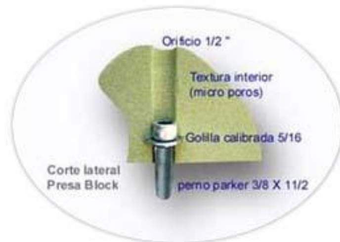
Fig. 1.2 Corte lateral de presa
