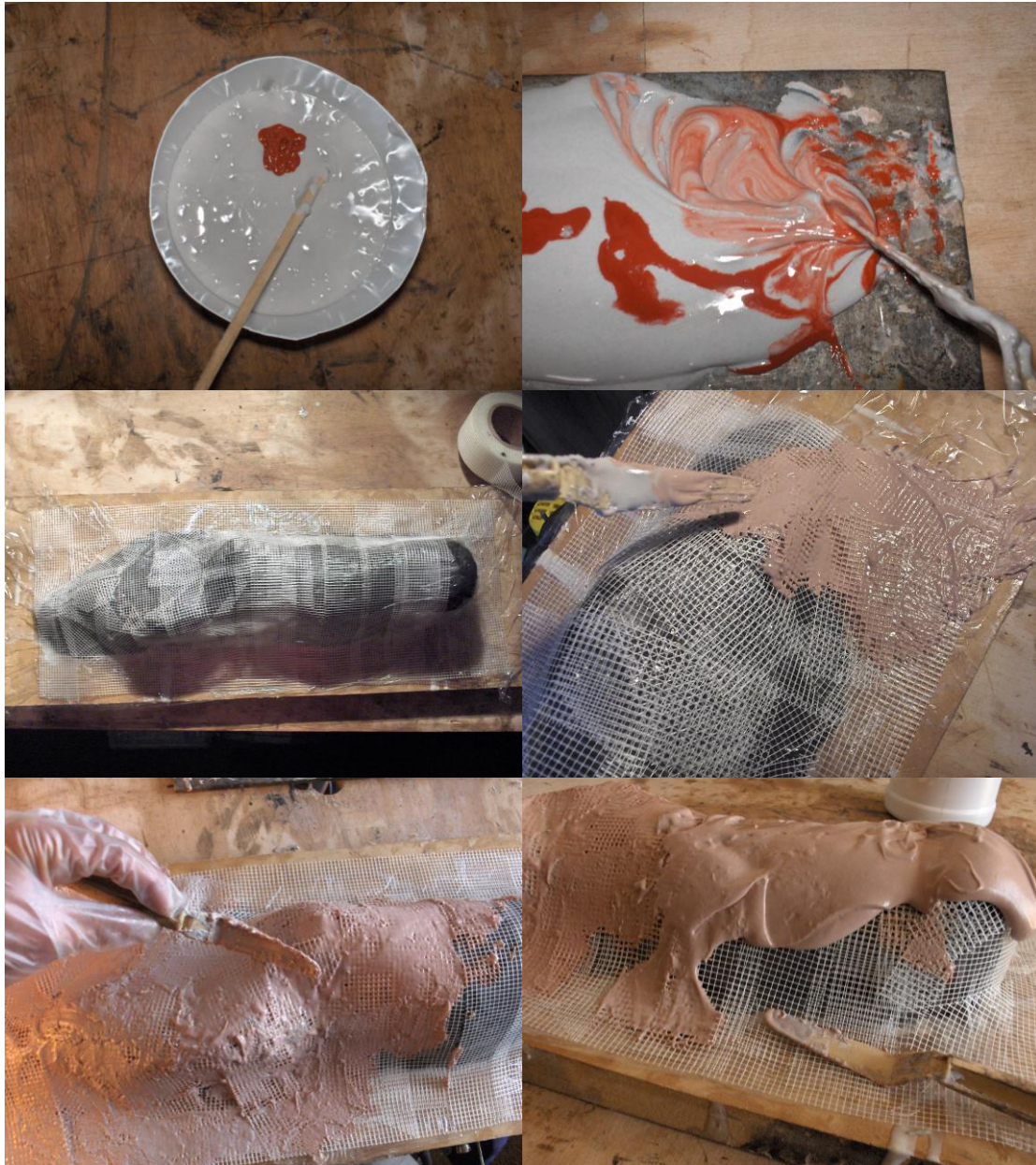
Fig.3.16 Preparación de masilla plástica y contramoldeo
