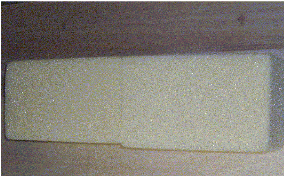
Fig. 3.9 Adhesión de bloques de estirofoam
