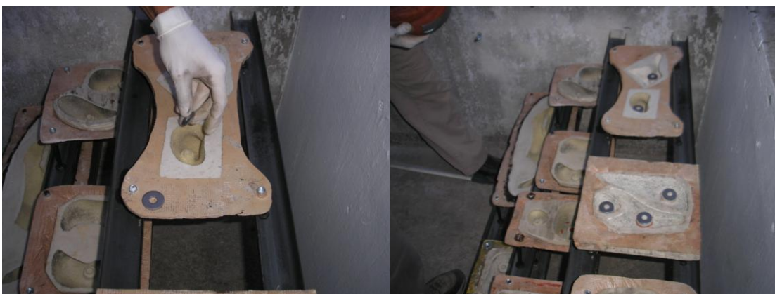
Fig. 3.27 Colocación de arandelas
