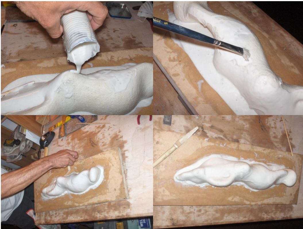
Fig. 3.14 Aplicación de silicona
