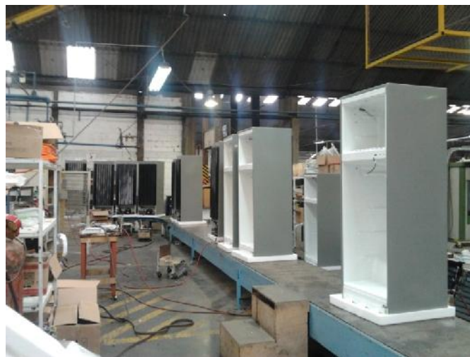
Figura 3.21. Banda Transportadora del proceso de ensamble.
