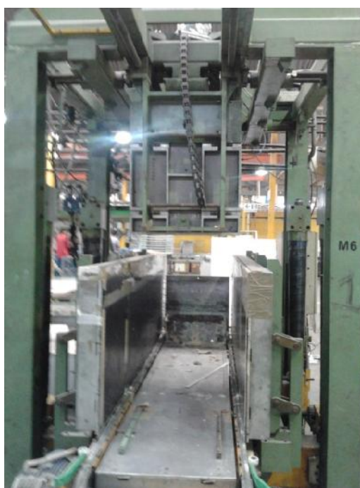
Figura 3.19. Inyectora de Aislante
