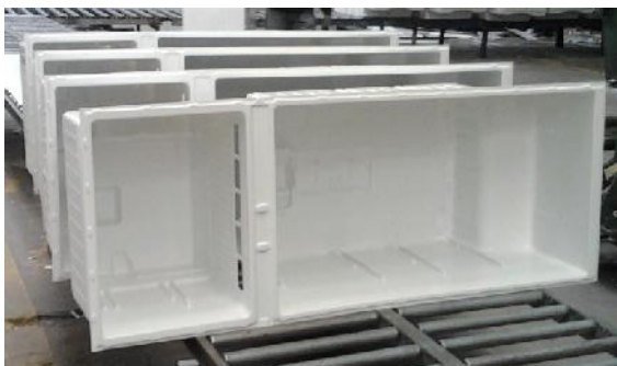
Figura 3.16. Tanque del gabinete
