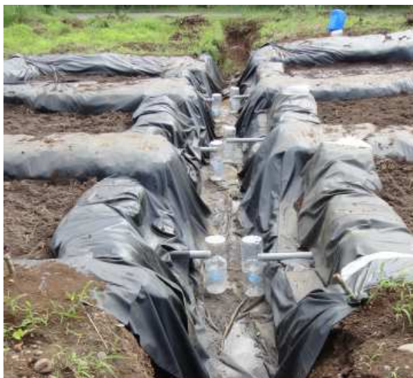
Figura 2.4 Fotografía de la plataforma lista para la plantación y siembra de especies vegetales y montaje del ensayo (Muso, 2012).
