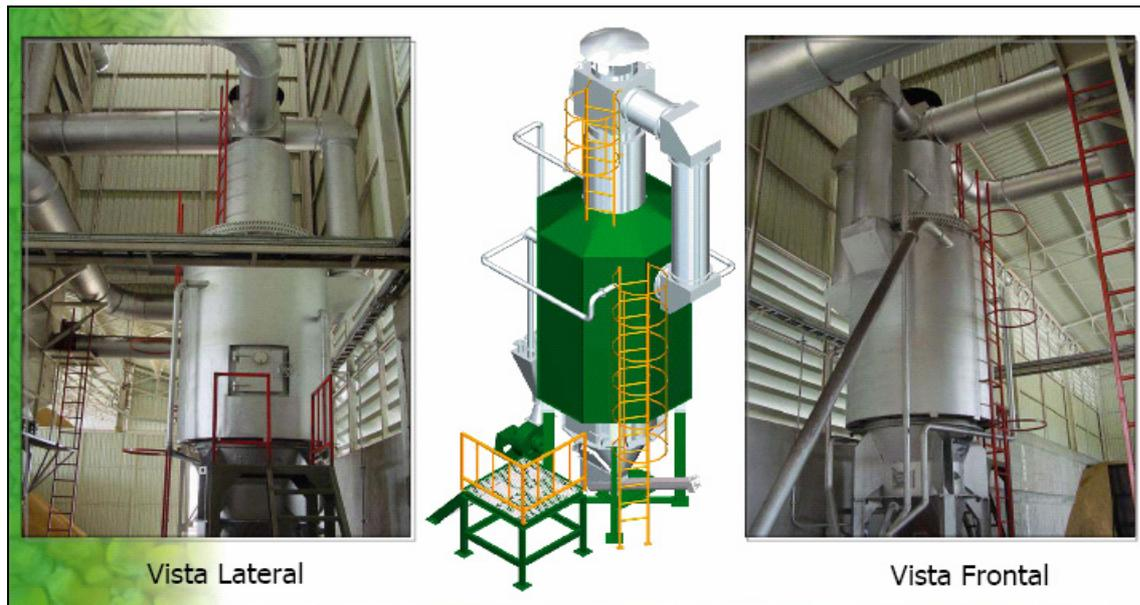
**Figura 1.2** Horno quemador de biomasa de la empresa Super Brix
