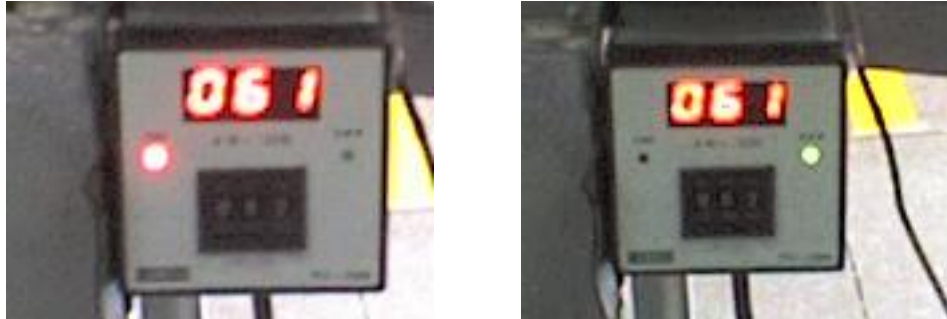
Figura 6.15. Control de temperatura interior de la cámara.
