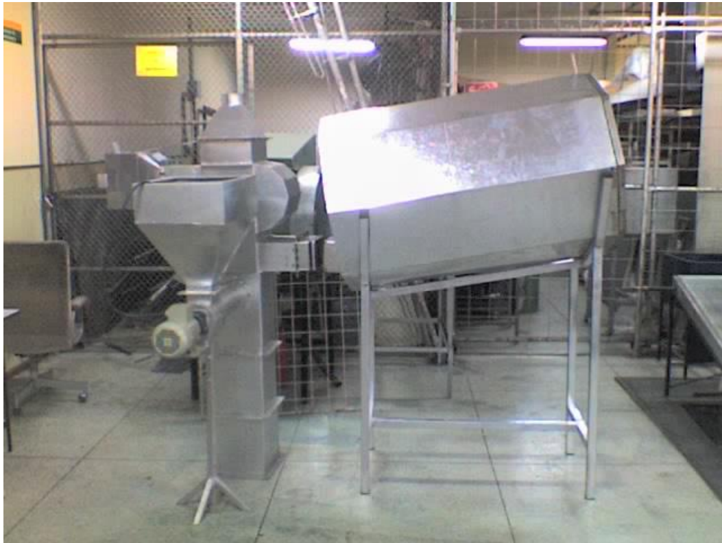
Foto 1: Horno, soporte e intercambiador de calor (vista lateral).
