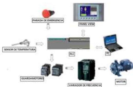
Figura. 14. Arquitectura del Sistema de Control. Implementación
