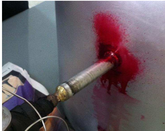
Figura 4. 1 Líquido penetrante en costuras externas del cilindro
