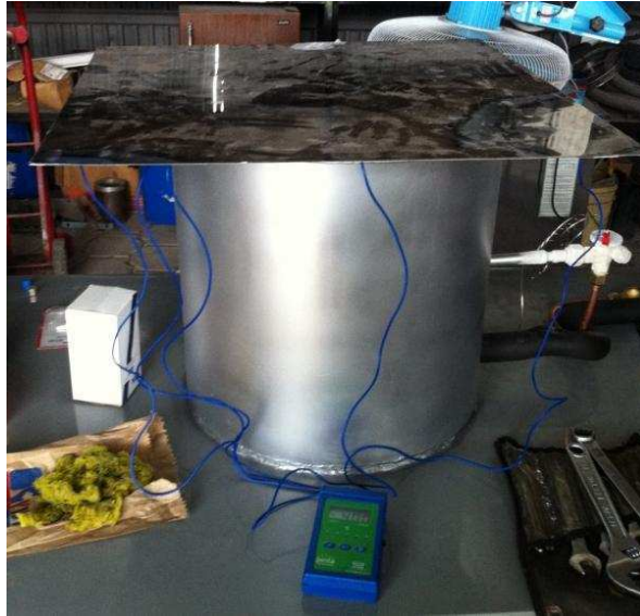
Figura 4. 11 Prueba de temperatura del sistema de refrigeración.
