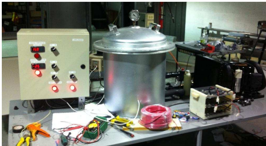
Figura 3. 37 Ensamblaje final de los elementos de la máquina
