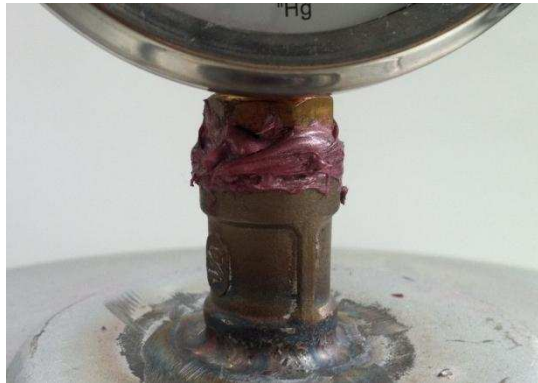
Figura 2. 9 Sensor de vacío o vacuómetro utilizado
