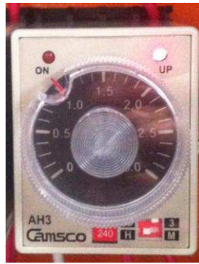
Figura 2. 36 Temporizador on delay marca Camsco
