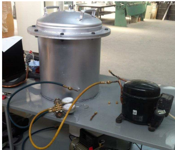
Figura 4. 5 Prueba de hermeticidad por aire comprimido
