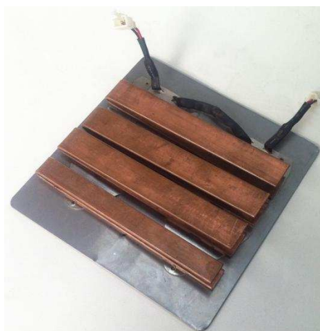
Figura 4. 13 Barras de cobre acopladas a las niquelinas
