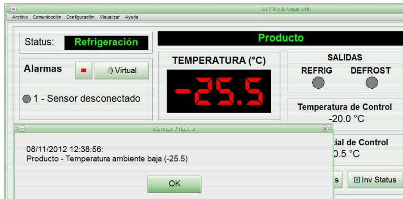
Figura 2. 44 Alarma de temperatura baja.
