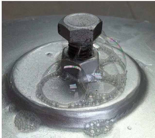
Figura 4. 6 Presencia de burbujas en el acople para el vacuómetro
