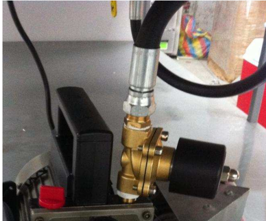
Figura 2. 11 Acoples de mangueras en bombas de vacío
