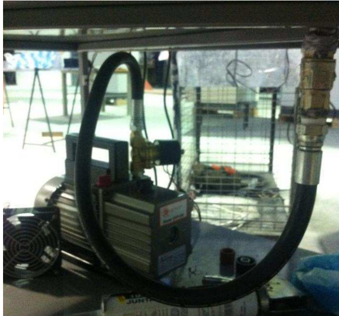
Figura 3. 42 Conexión final cámara - bomba de vacío
