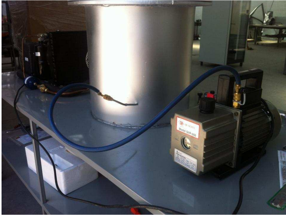
Figura 3. 41 Conexión inicial cámara - bomba de vacío
