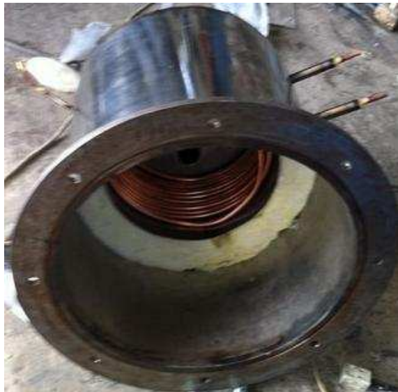
Figura 3. 20 Poliuretano en la cámara.
