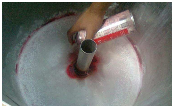
Figura 4. 2 Aplicación del líquido penetrante en costuras internas
