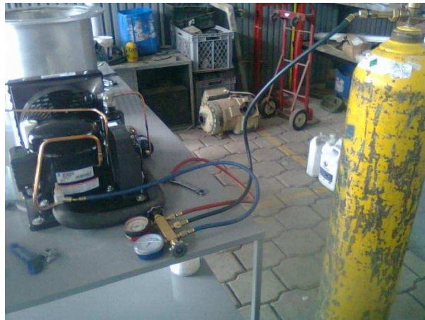
Figura 4. 8 Prueba de fugas para el sistema de refrigeración
