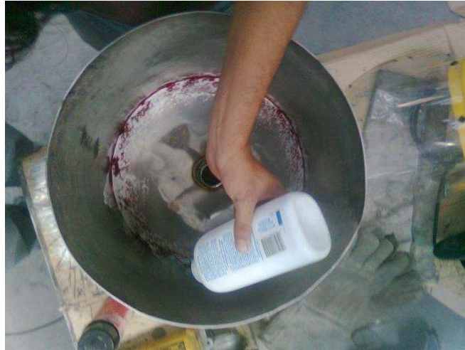
Figura 4. 3 Aplicación del revelador en costuras internas del cilindro.
