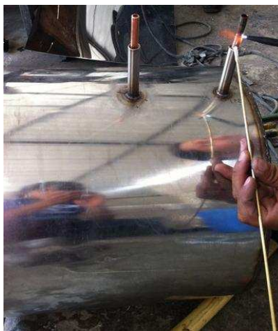
Figura 3. 19 Suelda de entrada y salida del evaporador.
