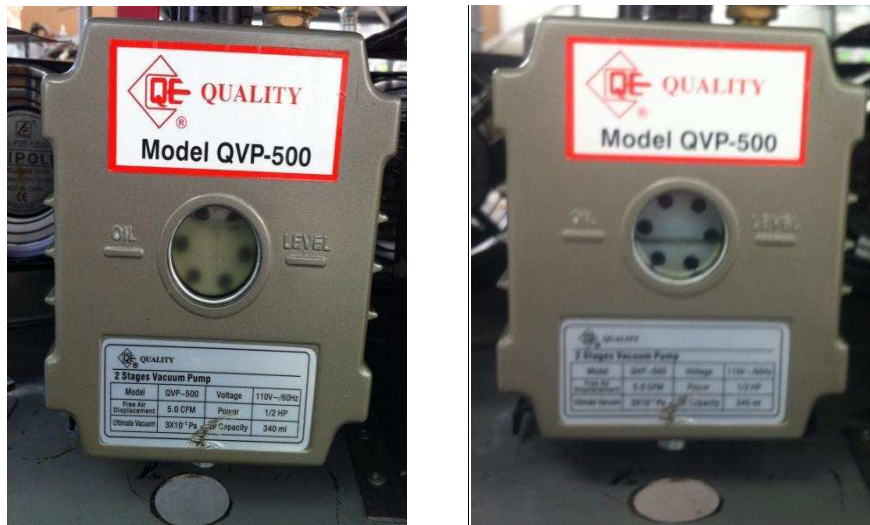
Figura 4. 29 Estado de aceite con impurezas y estado recomendado
