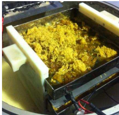
Figura 4. 14 Sistema de calentamiento por barras de cobre
