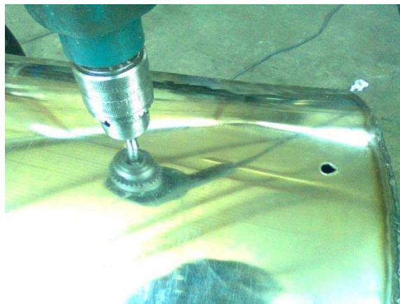
Figura 3. 6 Perforación para el acople del evaporador
