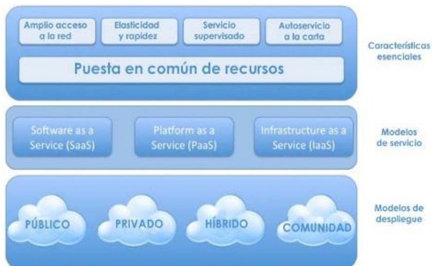
11 Figura 3.4. Arquitectura de Cloud Computing
