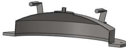
Figura 6. Estructura de la cabeza de la cámara liofilizadora.
