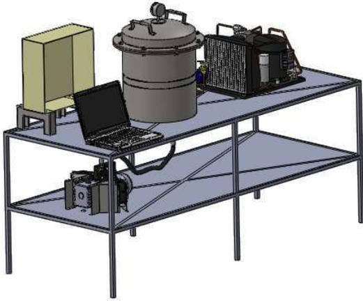
Figura 4. Diagrama del modelo liofilizador.
