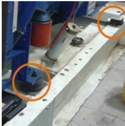
Figura 1. 8: Tacos anti vibrantes en el soporte
