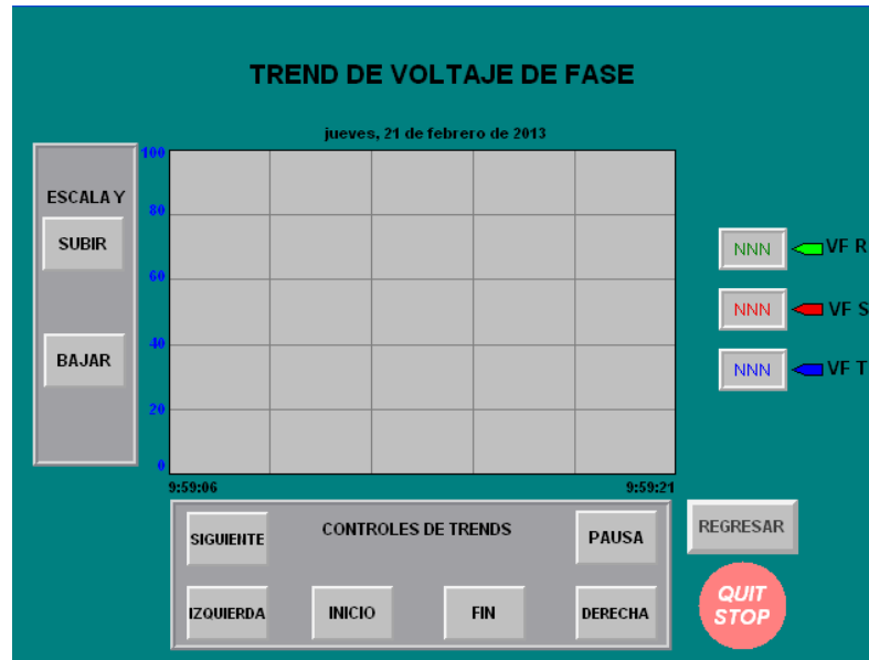
Figura U. 25: Pantalla de visualización de tendencias o Trends de Voltajes de Fase
