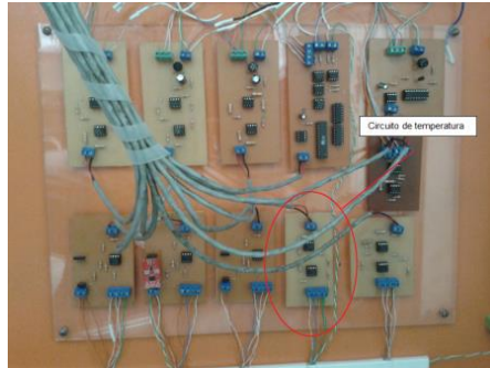
Figura 2. 8: Ensamble del circuito de temperatura en la placa de la caja
