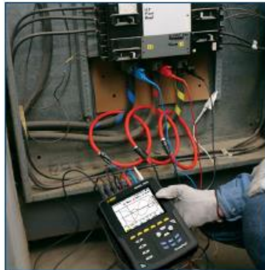
Análisis de calidad de potencia sobre un panel de tres fases utilizando las sondas de corriente flexibles AmpFlex ® .
