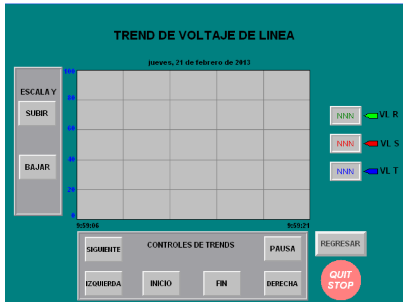
Figura U. 26: Pantalla de visualización de tendencias o Trends de Voltajes de Línea
