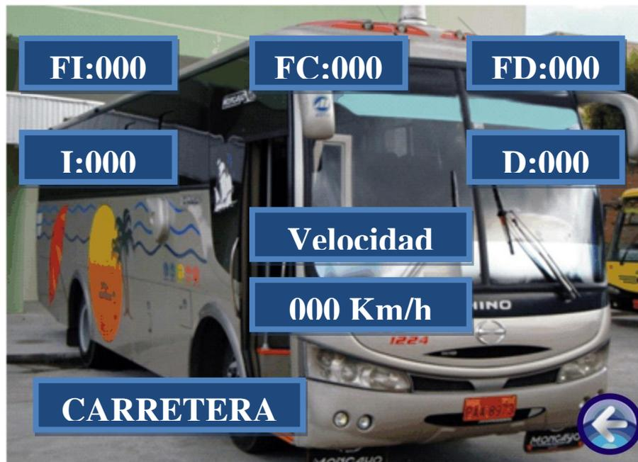
En este momento el sistema se activara, comenzara inmediatamente a medir la distancia a la que cualquier objeto se encuentre cerca del auto bus, además de activar el sistema de regulación de velocidad , la siguiente tabla detalla los elementos que se visualizan en la pantalla.
