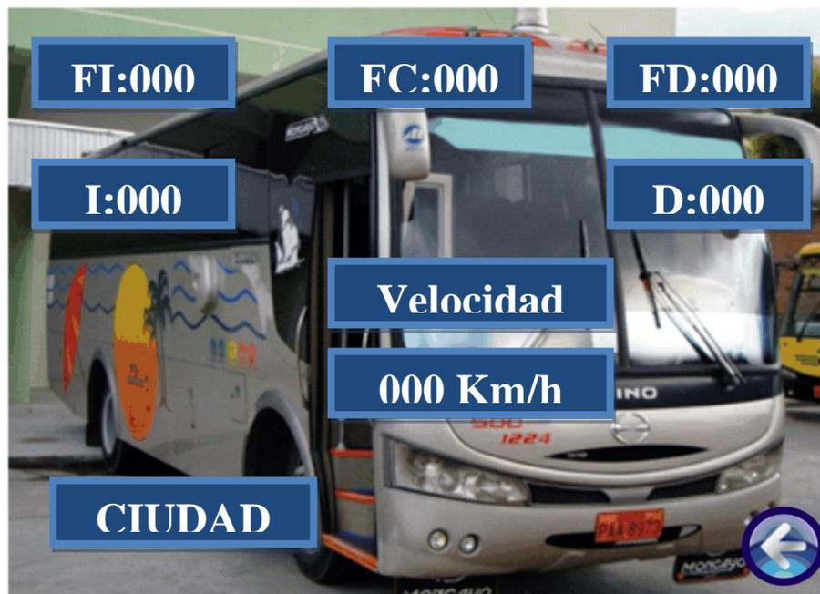
En este momento el sistema se activará, comenzará inmediatamente a medir la distancia a la que cualquier objeto se encuentre cerca del autobús, además de activar el sistema de regulación de velocidad, la siguiente tabla detalla los elementos que se visualizan en la pantalla.
