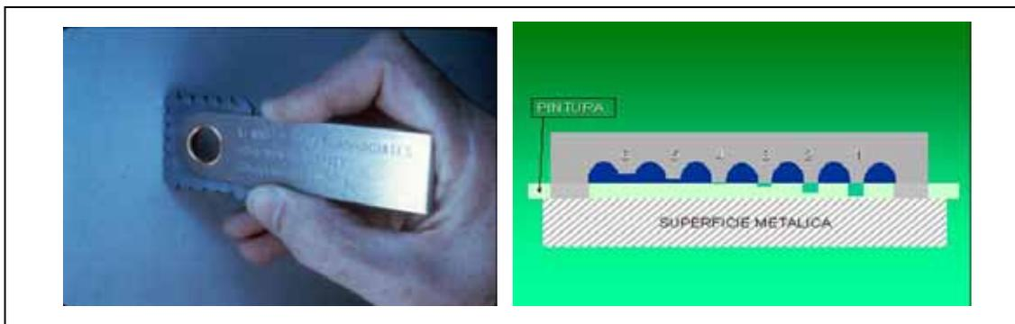
**Fig. 5.5 Calibrador en húmedo**
